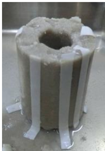
写真 2-2 試験後の状態（供試体 17(濃度 8%)）
