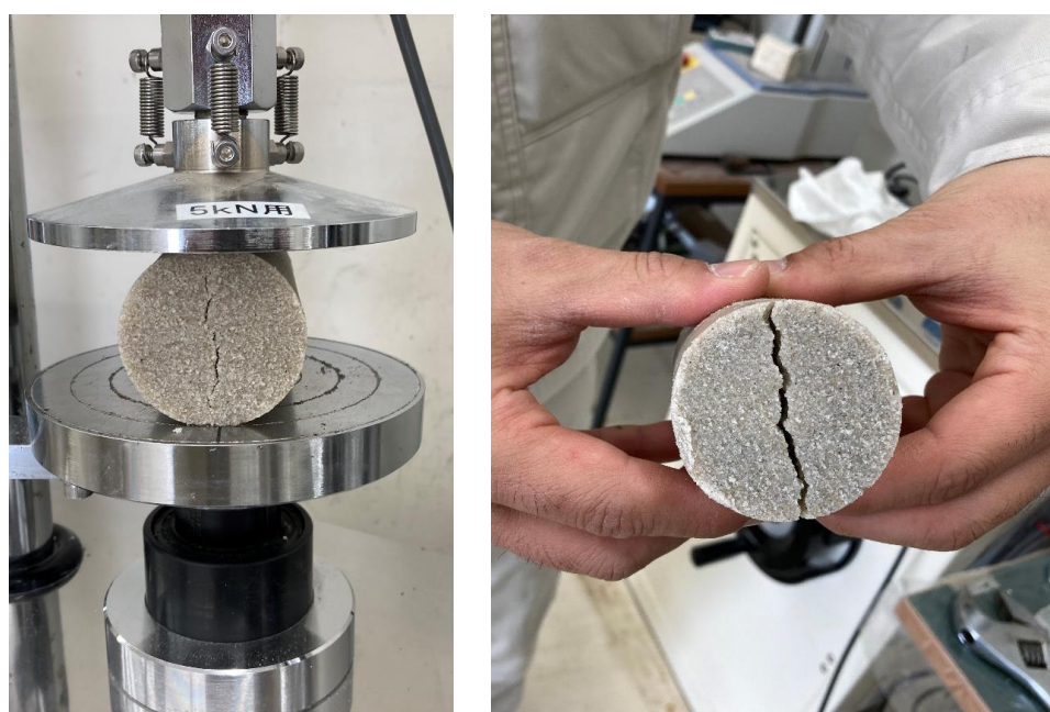
写真 3-4 圧裂引張り試験後の状況
