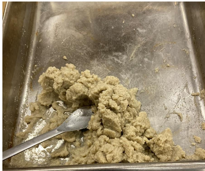
写真 3-6 薬液と試料の混合状況
