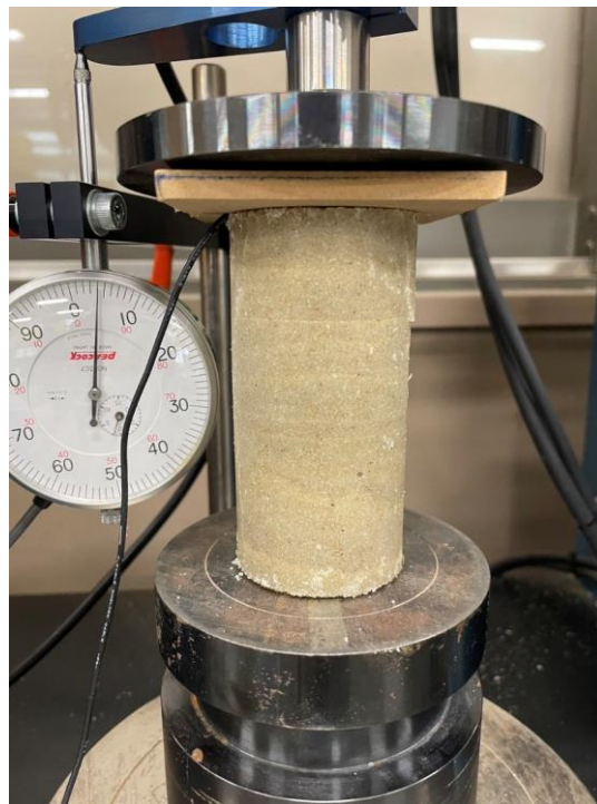
写真 3-3 一軸圧縮試験状況
