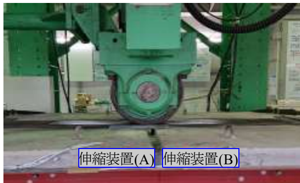
写真－ 6.4 輪荷重走行疲労実験状況
