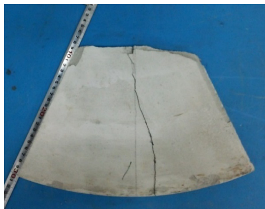
(b) f_{ck}=18.5\text{N/mm}^2 , \phi 319\text{-}\phi 882\text{②}
