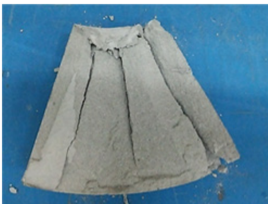
(a) f_{ck}=18.5\text{N/mm}^2 , \phi 114\text{-}\phi 307\text{③}
