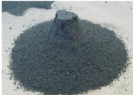
写真 3.2 CGS の表乾状態の例
