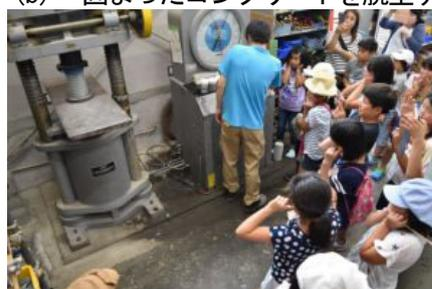
(d) 供試体の圧縮試験の様子
