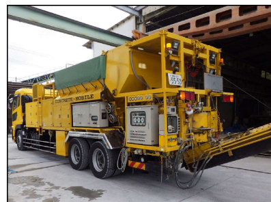
(2)移動プラントで練混ぜ
