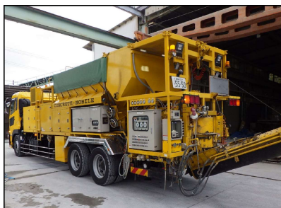
(4)移動プラントで練混ぜ
