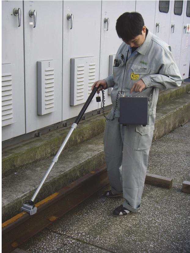
図 2.24 専用測定器によるレールの調査
