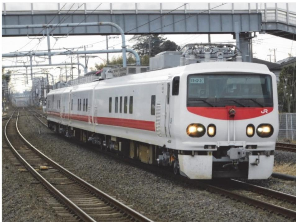
図 2.22 検測車によるレールの点検
