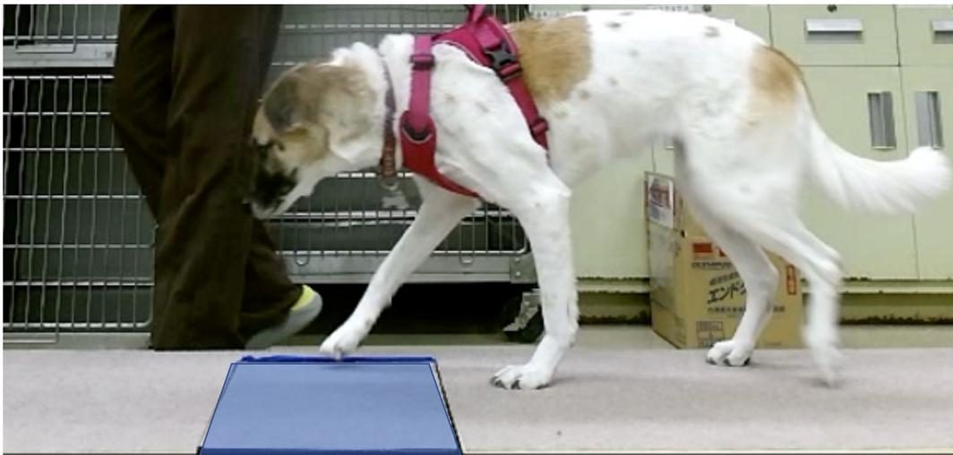
図 2-1 歩行動作中の四肢への荷重状態の測定方法
