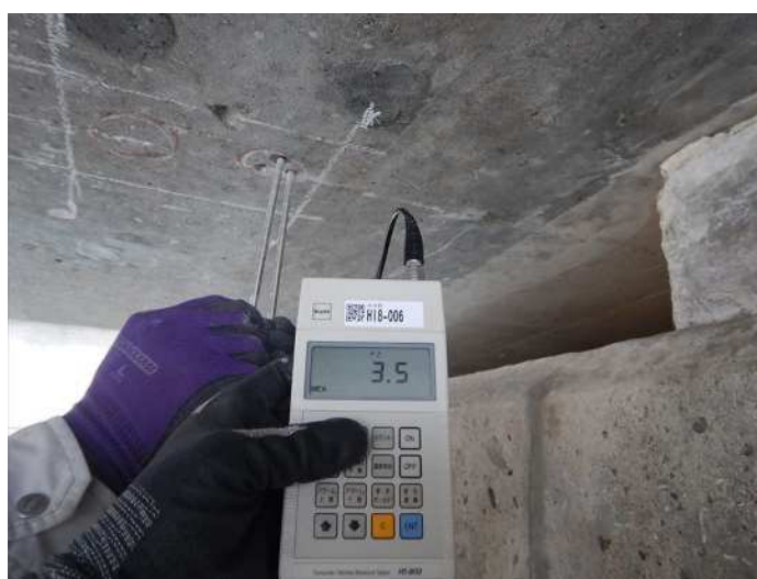
写真-4.2 含水率の測定状況
