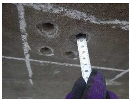
写真-4.9 ドリル法による採取実施状況
