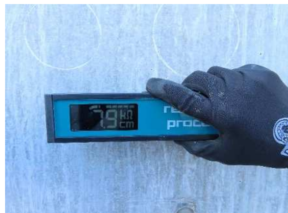
写真-5.23 電気抵抗率計測状況
