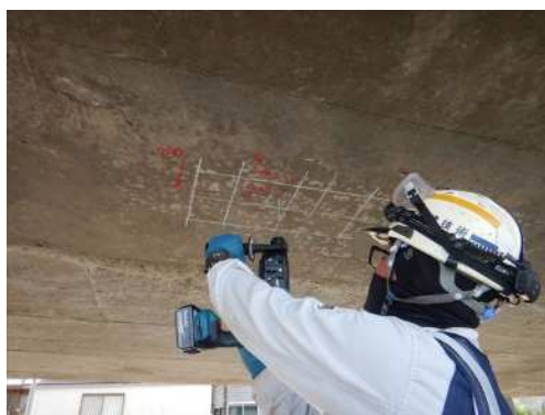
写真-5.24 ドリル法による採取実施状況
