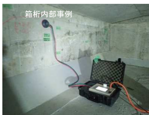
写真-4.12 表層透気試験計測状況
