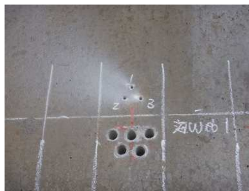
写真-5.25 ドリル法による試料採取後
