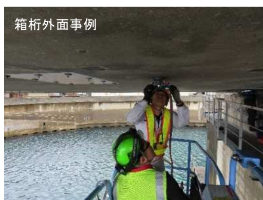
写真-4.12 表層透気試験計測状況
