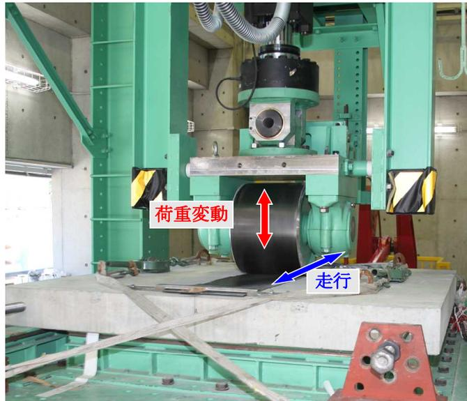
写真－ 3.1 輪荷重走行振動試験装置
