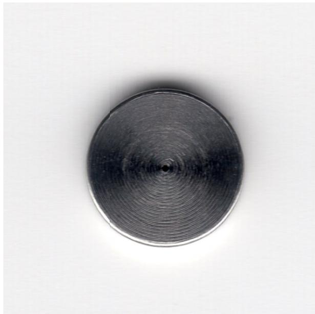
Fig. 37 マイクロホローカソード (電極のみ)
