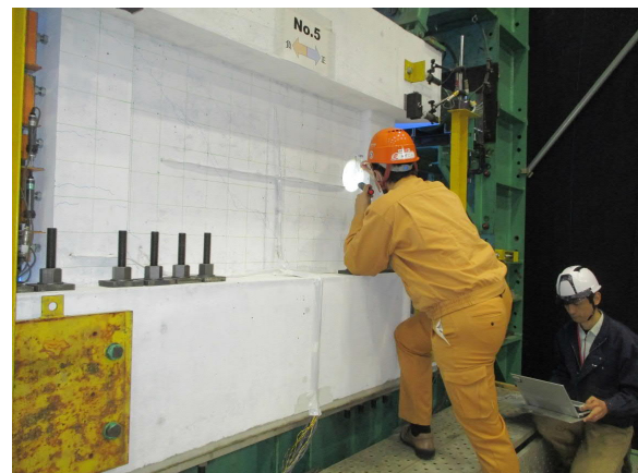
写真 3.3-3 ひび割れ幅計測状況
