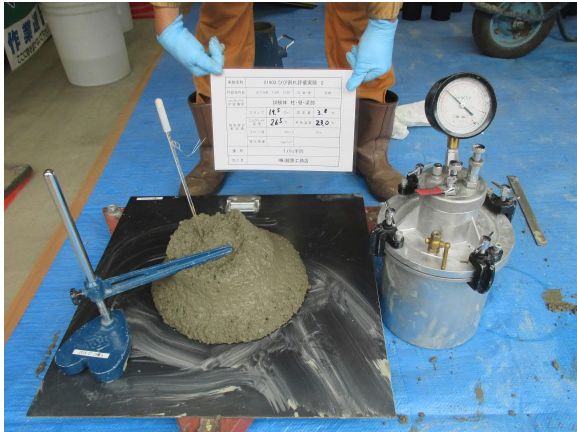
(c) 壁・柱・加力スタブコンクリート受入れ
