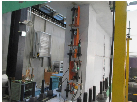
(b) 柱軸方向変位の計測
