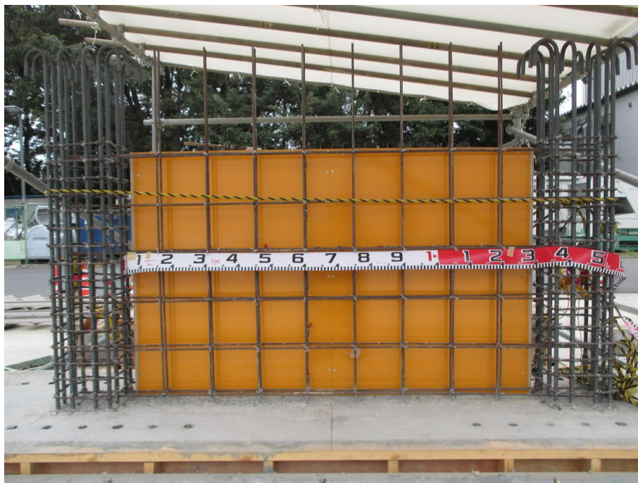
写真 3. 1-1 試験体 T85-p05-D6-W の壁配筋状況
