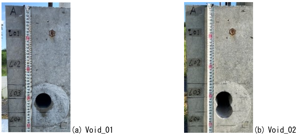
図 5.35 空洞削孔後の側面写真 (X=800mm における Y-Z 平面)
