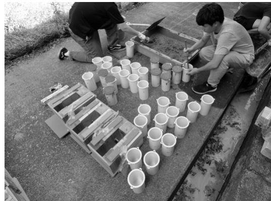
写真 1-12 テストピース作成
