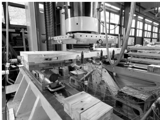
写真 2-1 試験体変位測定面 (複合床スラブ)
