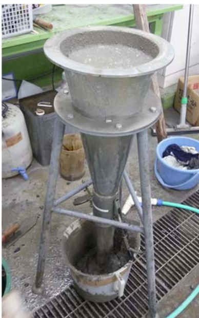
写真 2-3 ○ 漏斗流下試験器
