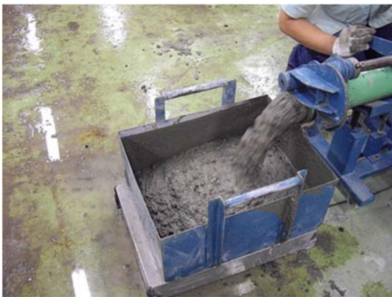
写真 3-3 管型粘度計の排出口
