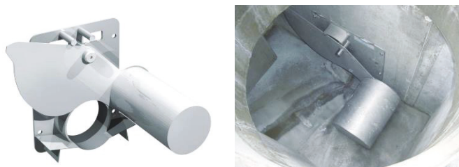
雨水吐き室の水位が上昇すると遮集管断面が縮小し遮集量は一定となる 写真 6.15 フローレギュレーター（ドイツ Steinhardt 社パンフレットより）
