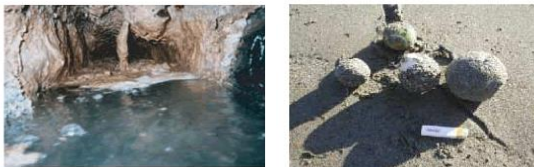
写真 2.2 管内に付着した油・ラード(左)とお台場海浜公園に漂着したオイルボール(右)
