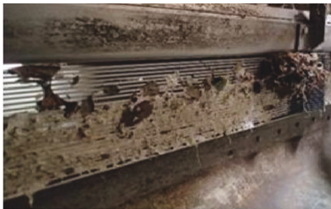
写真 6.13 ケース B のスクリーン付着状況
