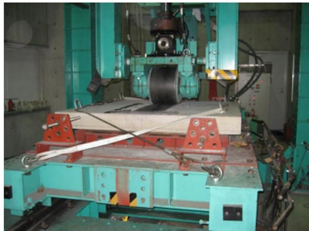
写真－ 6.1 輪荷重走行疲労装置
