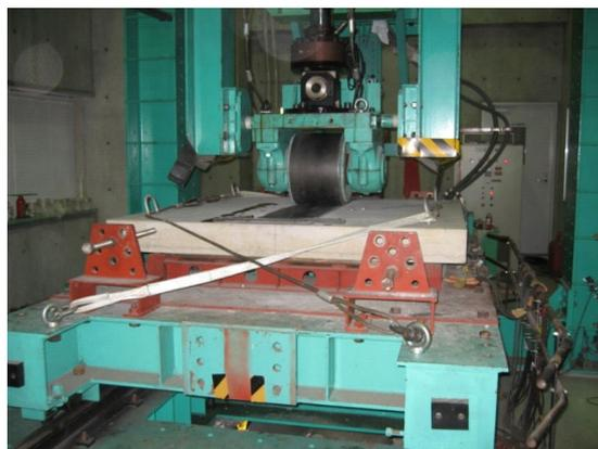
写真－ 5.4 輪荷重走行疲労装置
