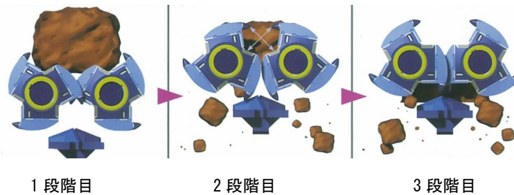
図 3.1.6 破碎機の開口幅・破碎仕組み
