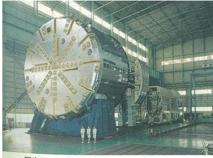
図 2.1.3 飛驒トンネルTBM (φ12.84m) 1)
