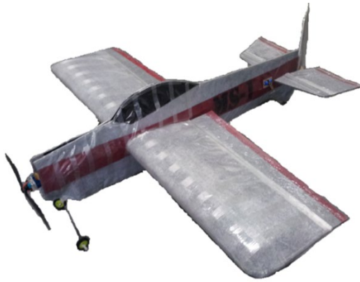
図 1.4 ホバリング機能を有する固定翼 UAV[Kohno14, Hatori13]
