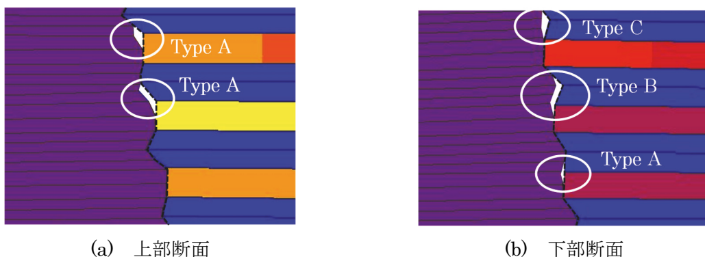
(a) 上部断面 (b) 下部断面 図 5-5(2) セン断ひずみ 25%時における加力方向の接触状態 (面圧 -5.0\text{N/mm}^2 )
