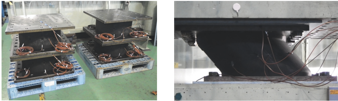
写真 2-1 試験体の外観（左）と試験機設置状況（右）
