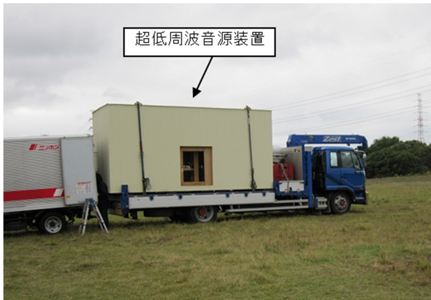
写真 2-7 超低周波音源装置
