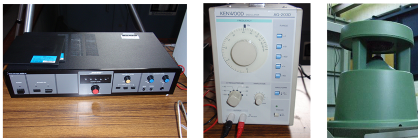
写真 2-4 実験機器 (左からアンプ, 低周波発振機, スピーカ)
