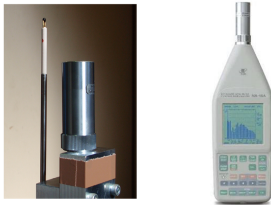
写真 2-2 実験機器 (写真：左から熱線流速計プローブ・マイクロホン, 低周波音計)
