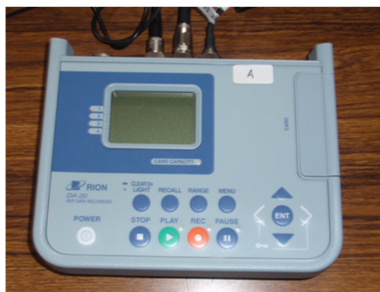
写真 2-3 実験機器 (データレコーダ)
