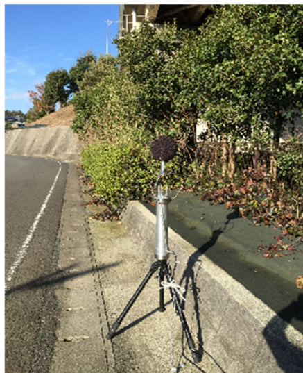
写真 5-1 風ノイズレベル計の設置状況
