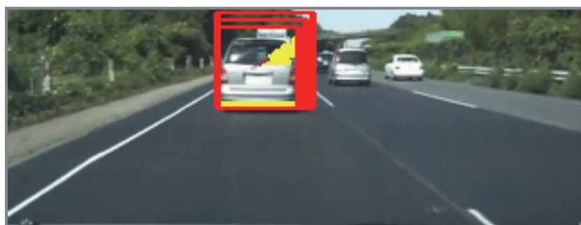
図 3.17 車両・非車両の識別の画像例
