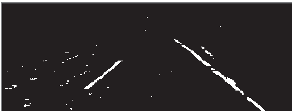
図 2.14 白線エッジのピーク特徴を利用したエッジ選別
