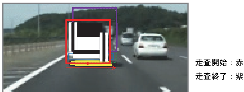
図 3.20 車両識別器適用のイメージ
