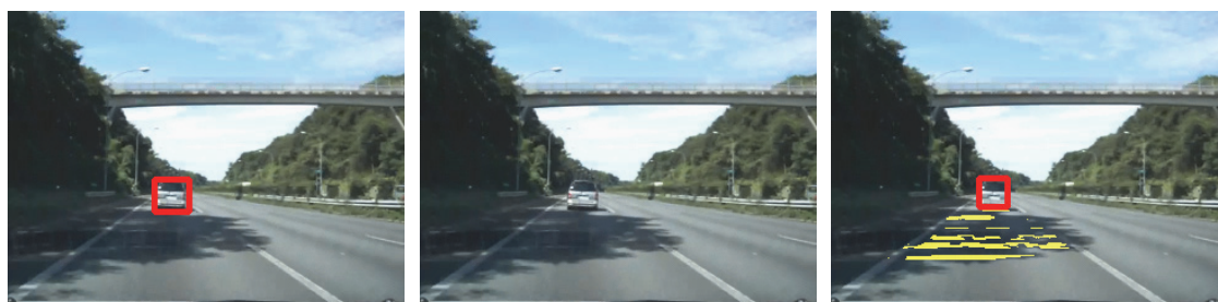
(a) SSD-VGG : 正検出 (b) SSD-Mobile : 未検出 (c) 提案手法 : 正検出
