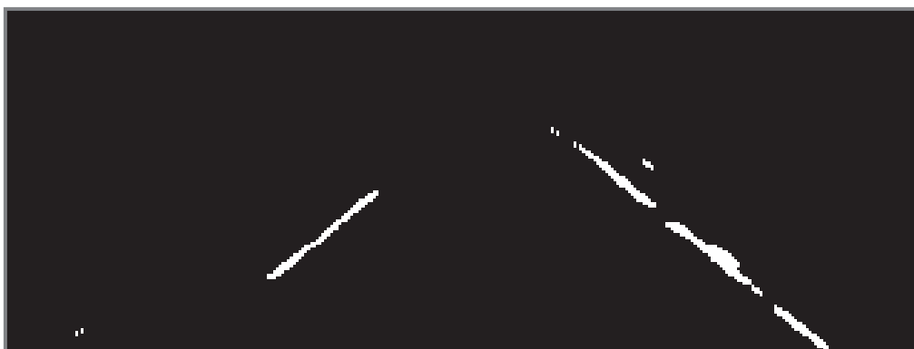
図 2.20 白線エッジの方向特性を利用したエッジ補正
