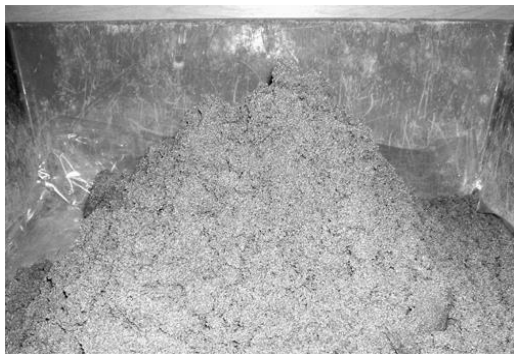
写真 3 - 9 地盤改良の練り上がり状況
