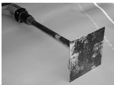
写真 3 - 4 バイブロタンパー
