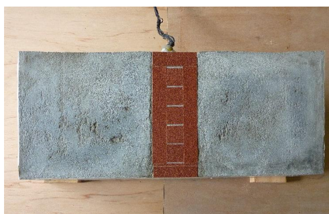
(d) 土圧測定装置の地盤に接する部分にサンドペーパー（ \phi_{\delta} =33.4°）を貼付
