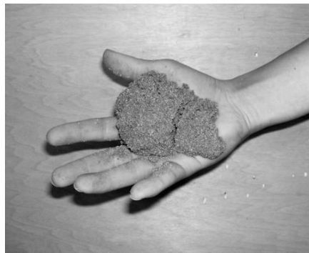
写真 3 - 9 地盤改良の練り上がり状況
