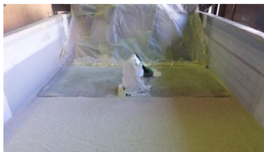
写真 5 - 1 静的地震載荷実験直前の地表面の状況
