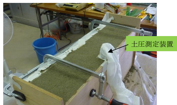
(b) 地盤改良打ち込み終了，試験体天端をコテで均す
