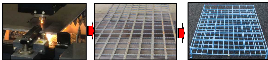
(1)レーザー加工 (2)格子鋼板筋 (3)組立て
