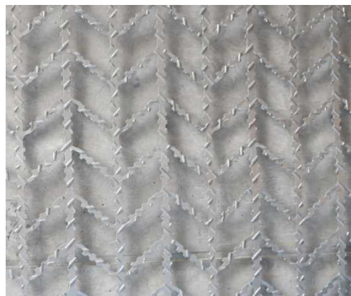
(2) 縞鋼板を用いた展張格子筋
