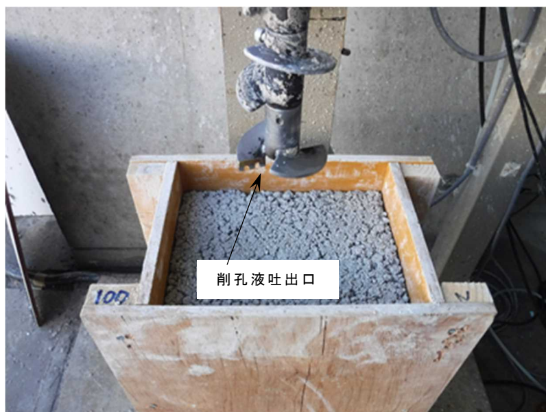
図 4.5 模擬試験用オーガー
