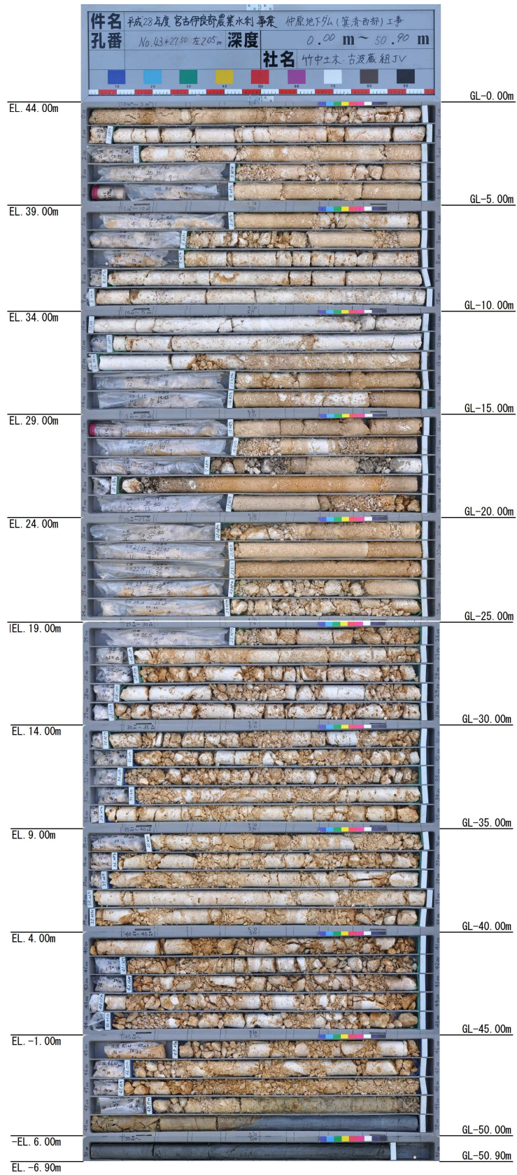
図 3.60 S-101 下流側ボーリングコア写真
