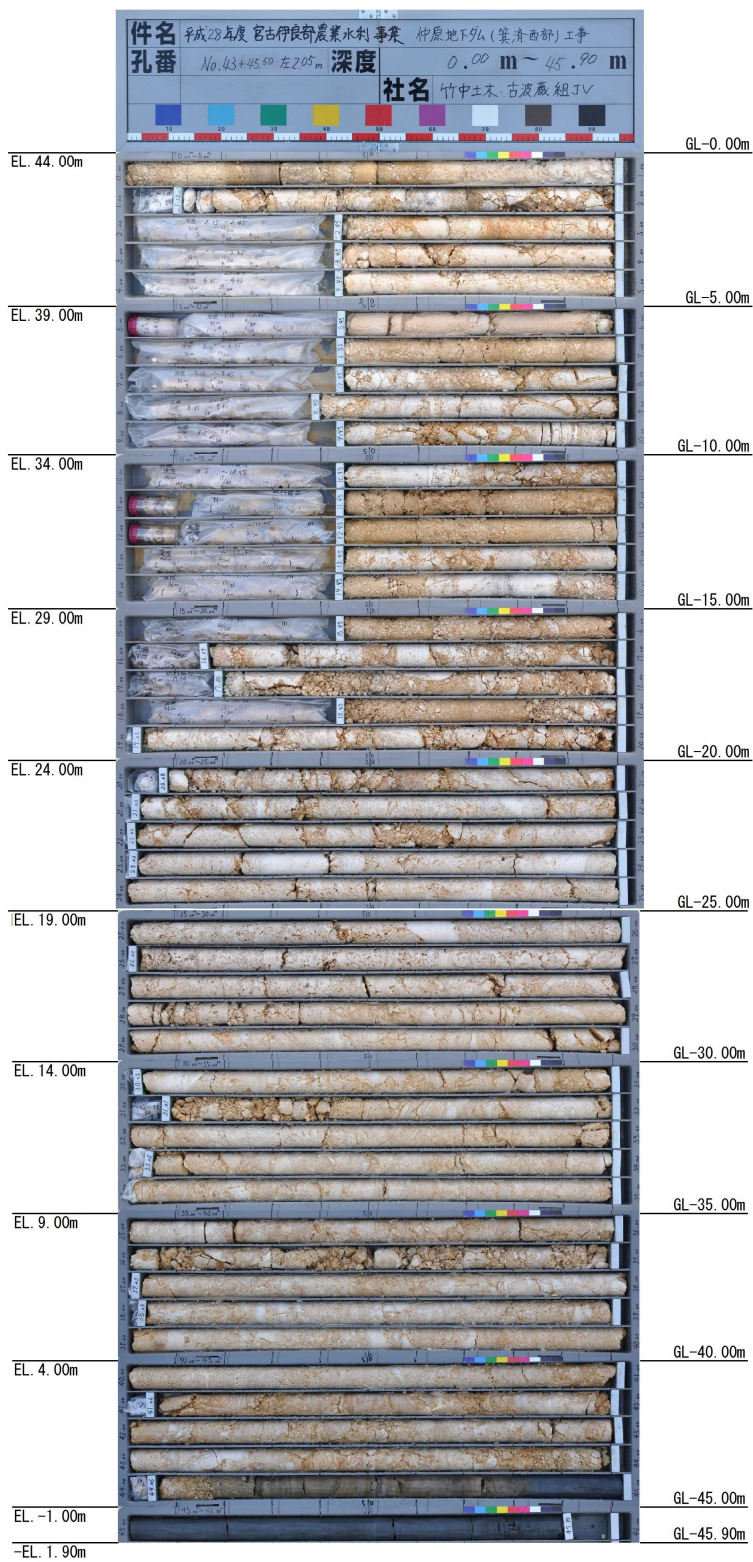
図 3.63 S-121 下流側ボーリングコア写真
