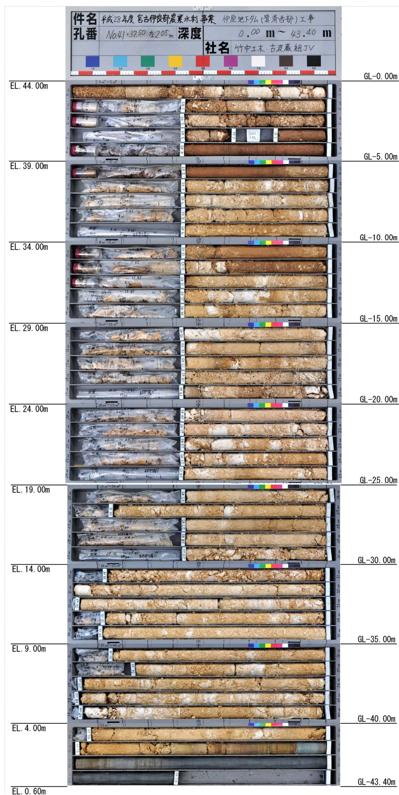
図 3.50 S-1 下流側ボーリングコア写真
