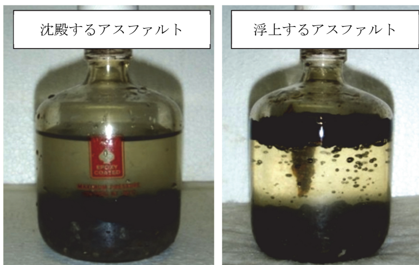
写真-2.2 気泡連行法による粒状アスファルトの浮上実験
