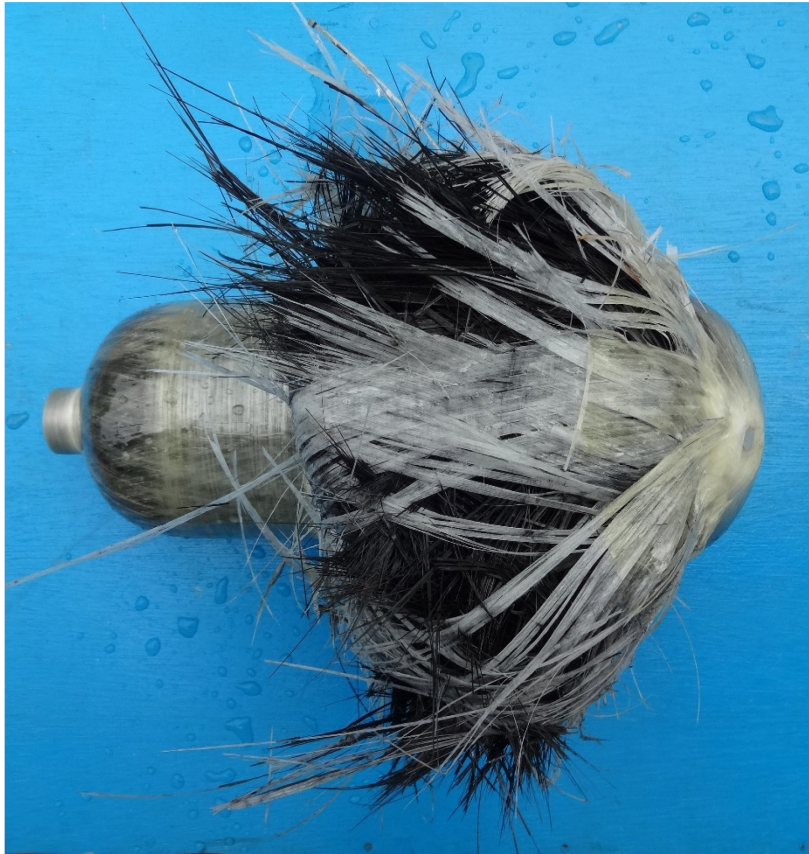
図 5.5 容器 A (Type-3) の破裂後の形状
