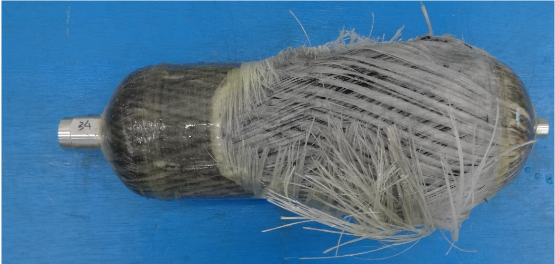
図 5.6 容器 B( Basic model)の破裂後の形状
