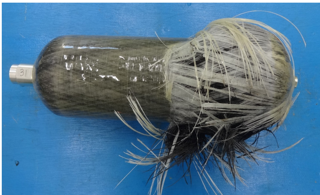
図 5.8 容器 D( Modified model_2)の破裂後の形状
