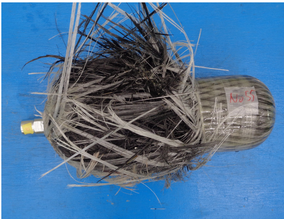
図 5.9 容器 E( Modified model_3)の破裂後の形状
