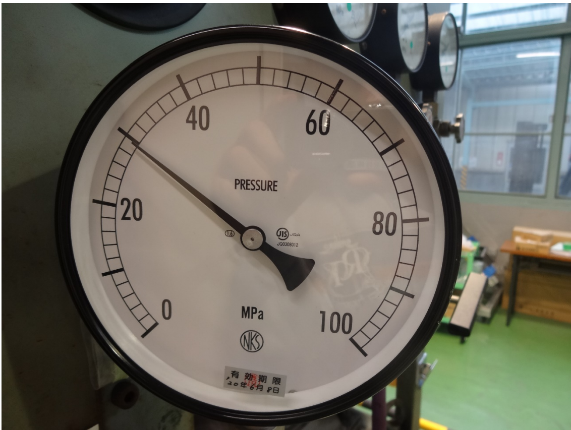
図 5.33 サイクル試験装置の圧力計(試験圧力 29.4MPa 作用時)
