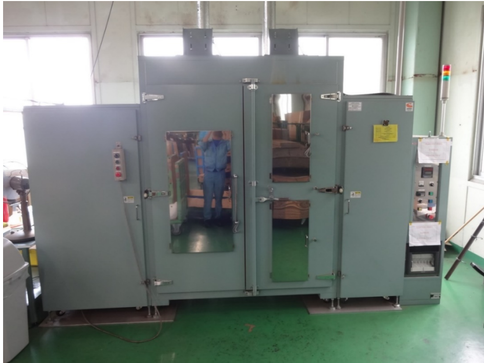
(a) 硬化炉の外観
