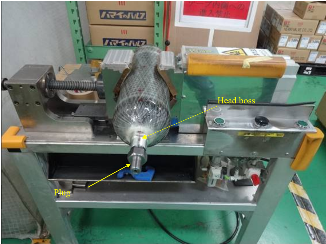
図 5.39 エアチャックによる容器の固定状況
