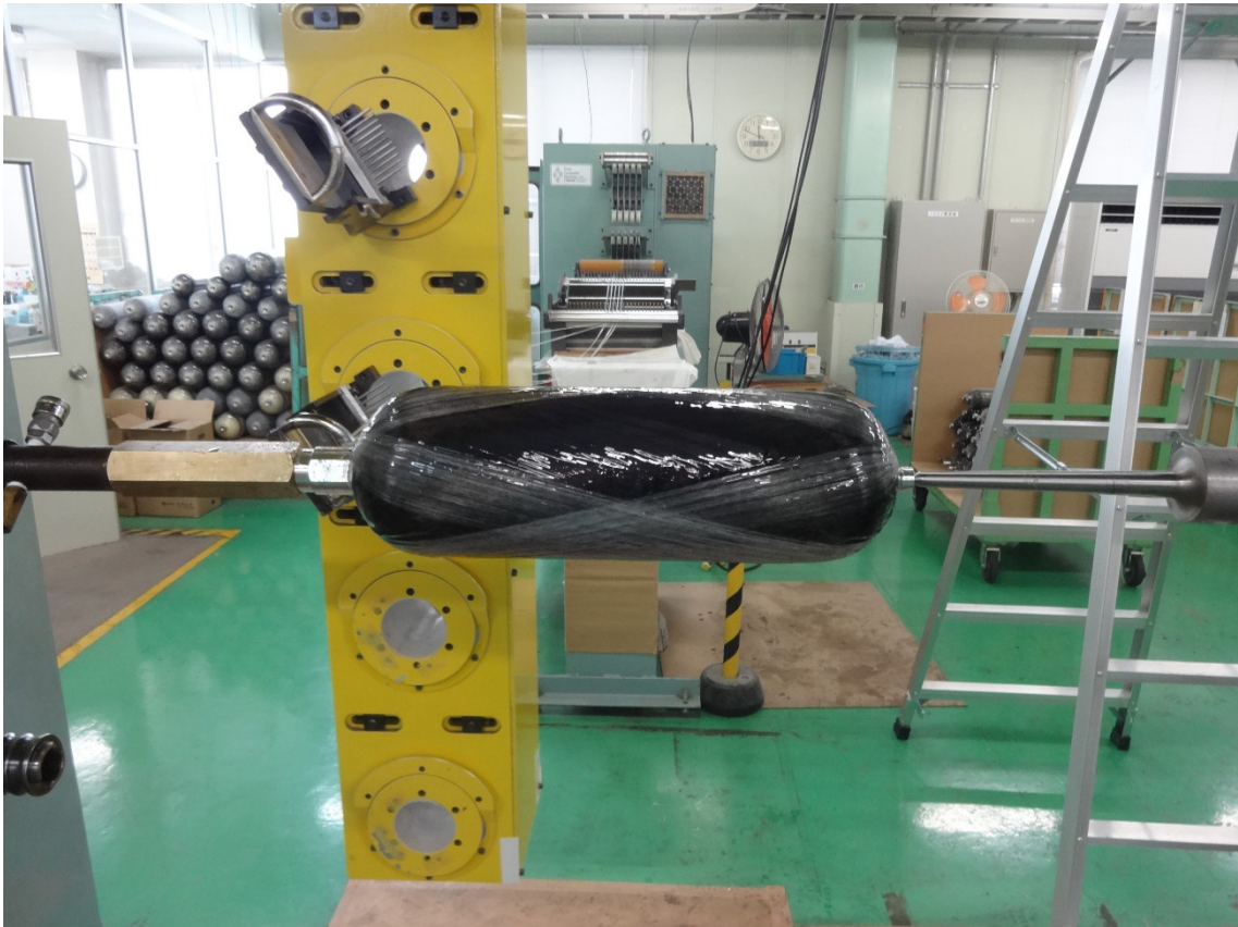
図 4.10 GFRP 層の FW 成形
