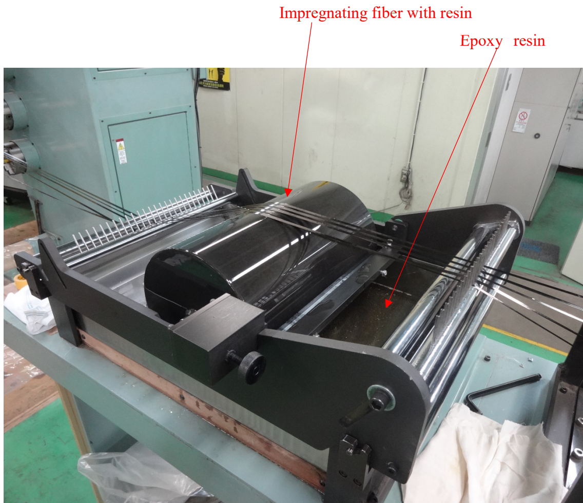
図 4.5 レジンバスによる樹脂含浸の様子
