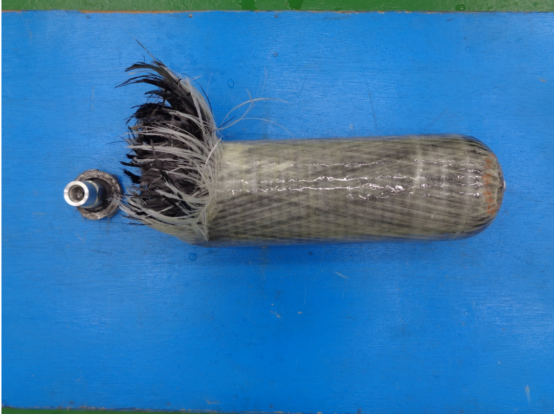
図 5.23 破裂試験後実施の容器形状
