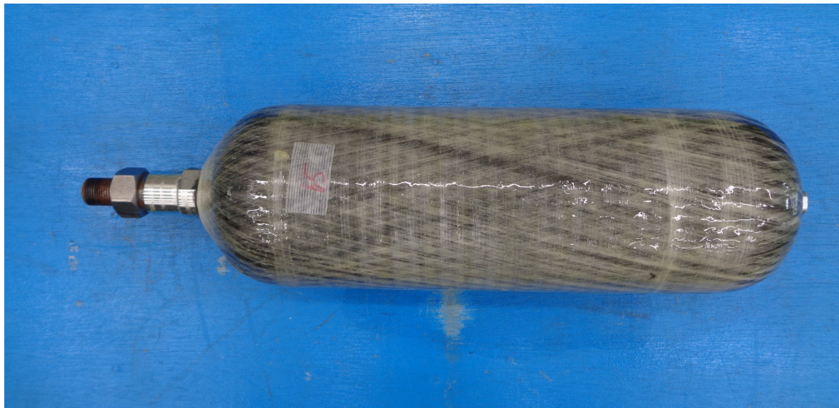
図 5.22 サイクル試験後の容器形状
