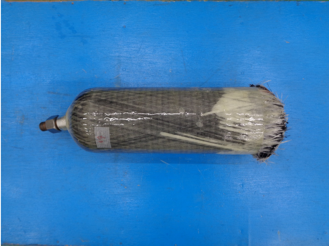
図 5.16 落下後の破裂試験実施後の容器 E の形状
