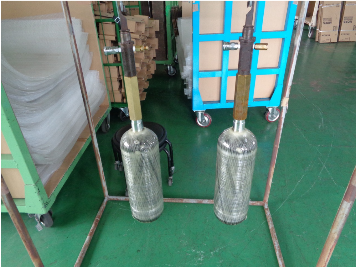
図 4.14 容器の空冷状況
