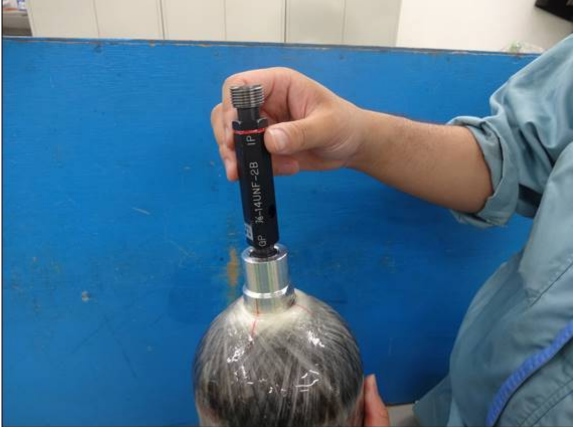
図 5.38 ねじゲージによるねじ形状確認の様子
