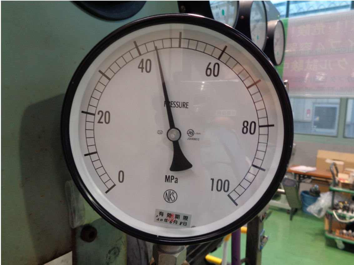
図 5.20 サイクル試験装置の圧力計(試験圧力 44.1MPa 作用時)
