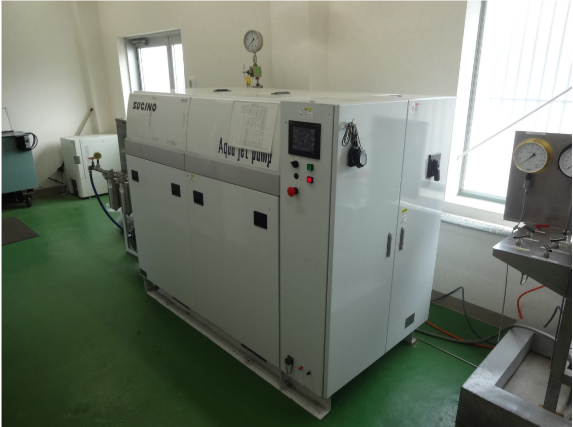
図 5.2 破裂試験装置
