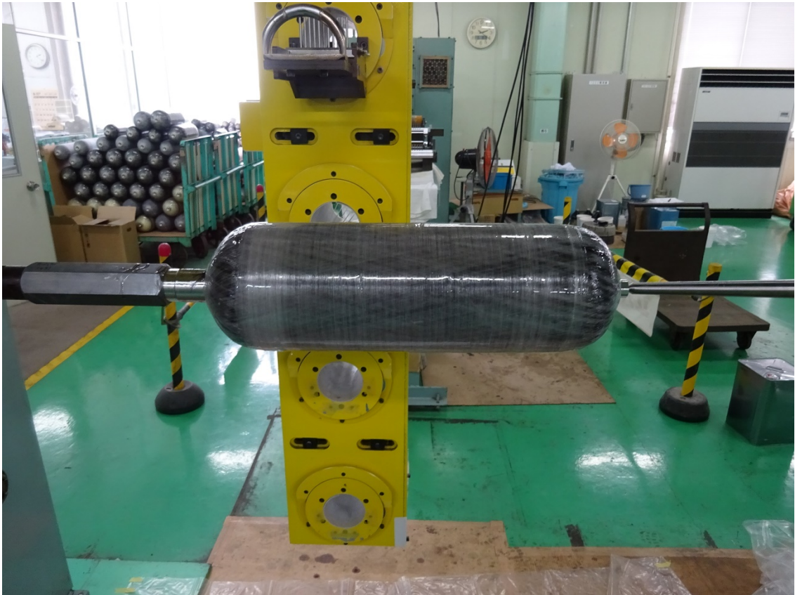
図 4.11 GFRP 層の FW 成形後の状態
