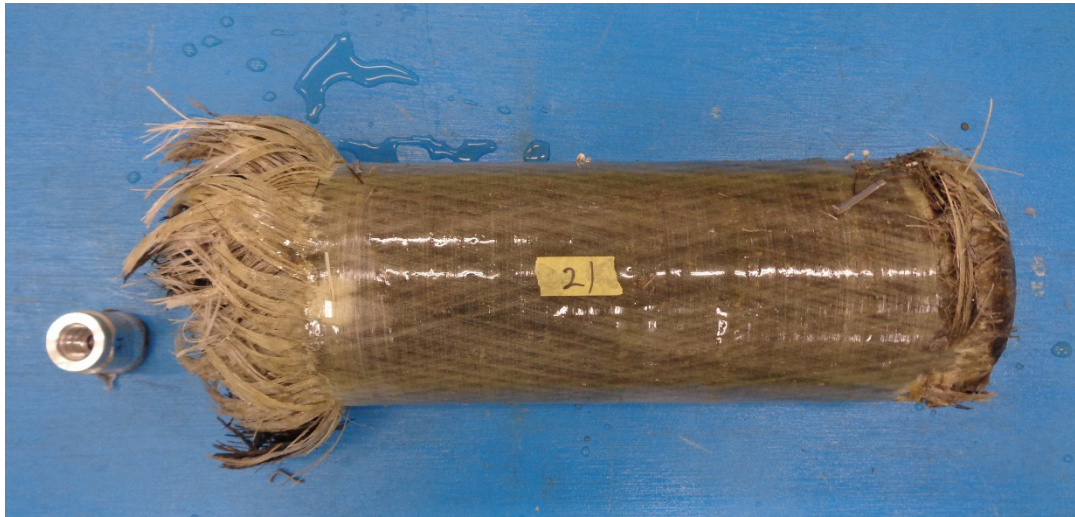
図 5.7 容器 C (Modified model_1) の破裂後の形状
