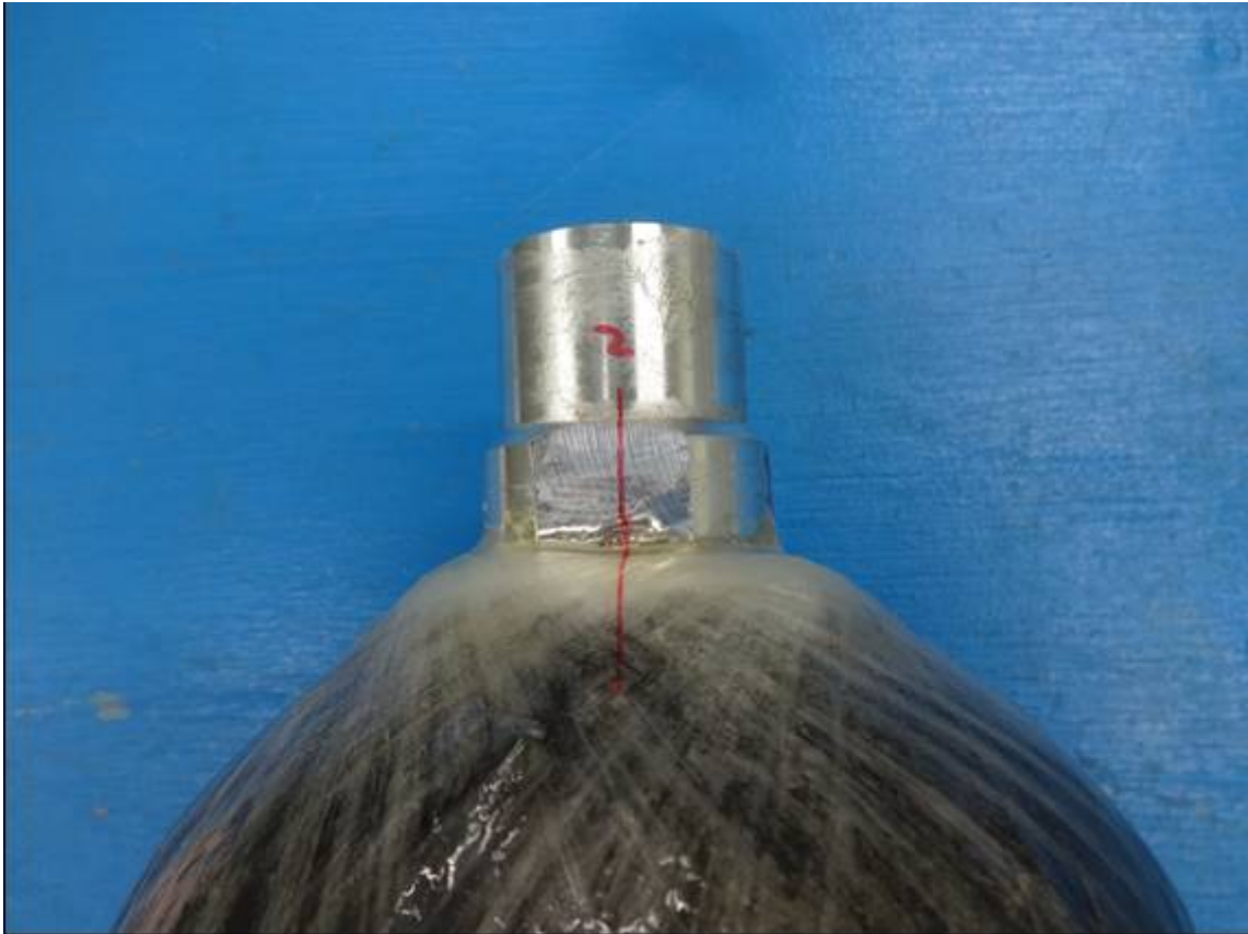
図 5.41 トルク試験後の頭部ボス口金部
