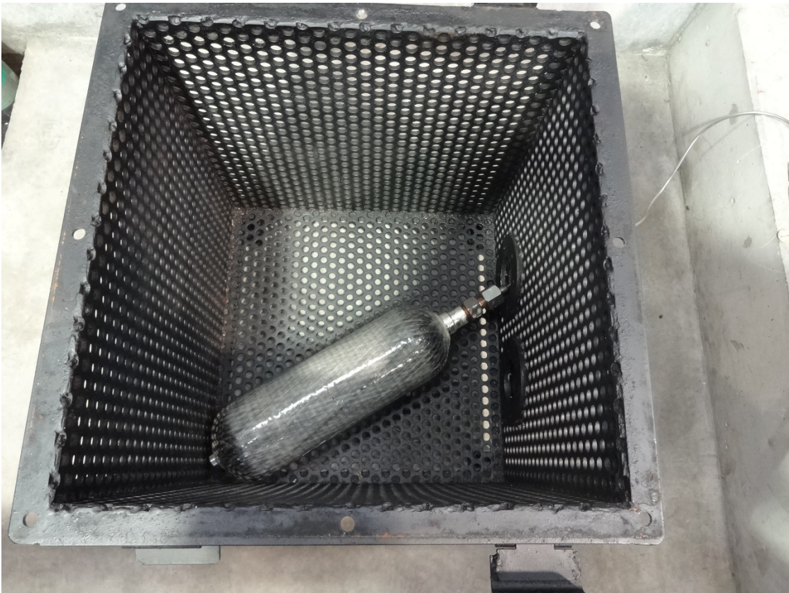
図 5.32 欠陥サイクル試験実施中の容器
