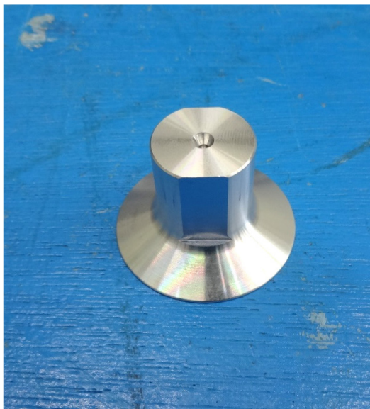
図 2.11 底部ボスロ金の外観形状
