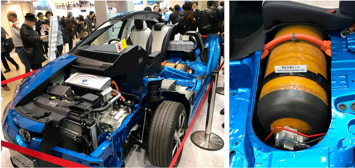
図 1.3 MIRAI に搭載された水素燃料タンク用 Type-4 容器
