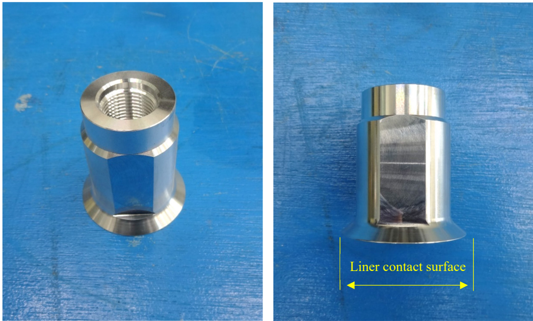
図 2.8 頭部ボス口金 a の外観形状
