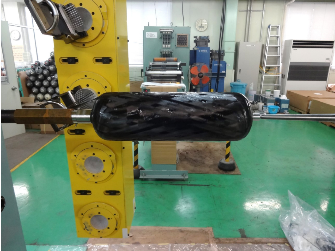
図 4.9 CFRP 層の FW 成形後の状態
