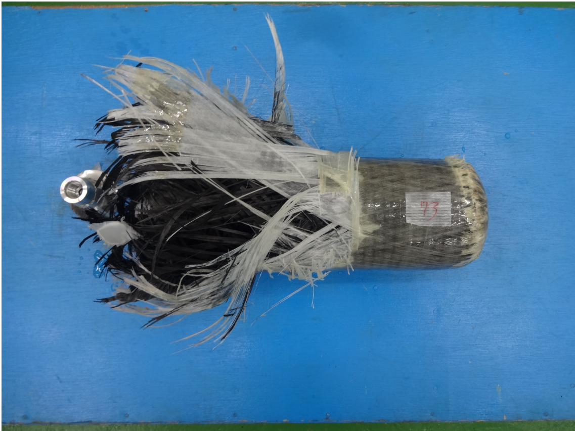
図 5.31 欠陥破裂試験実施後の容器形状
