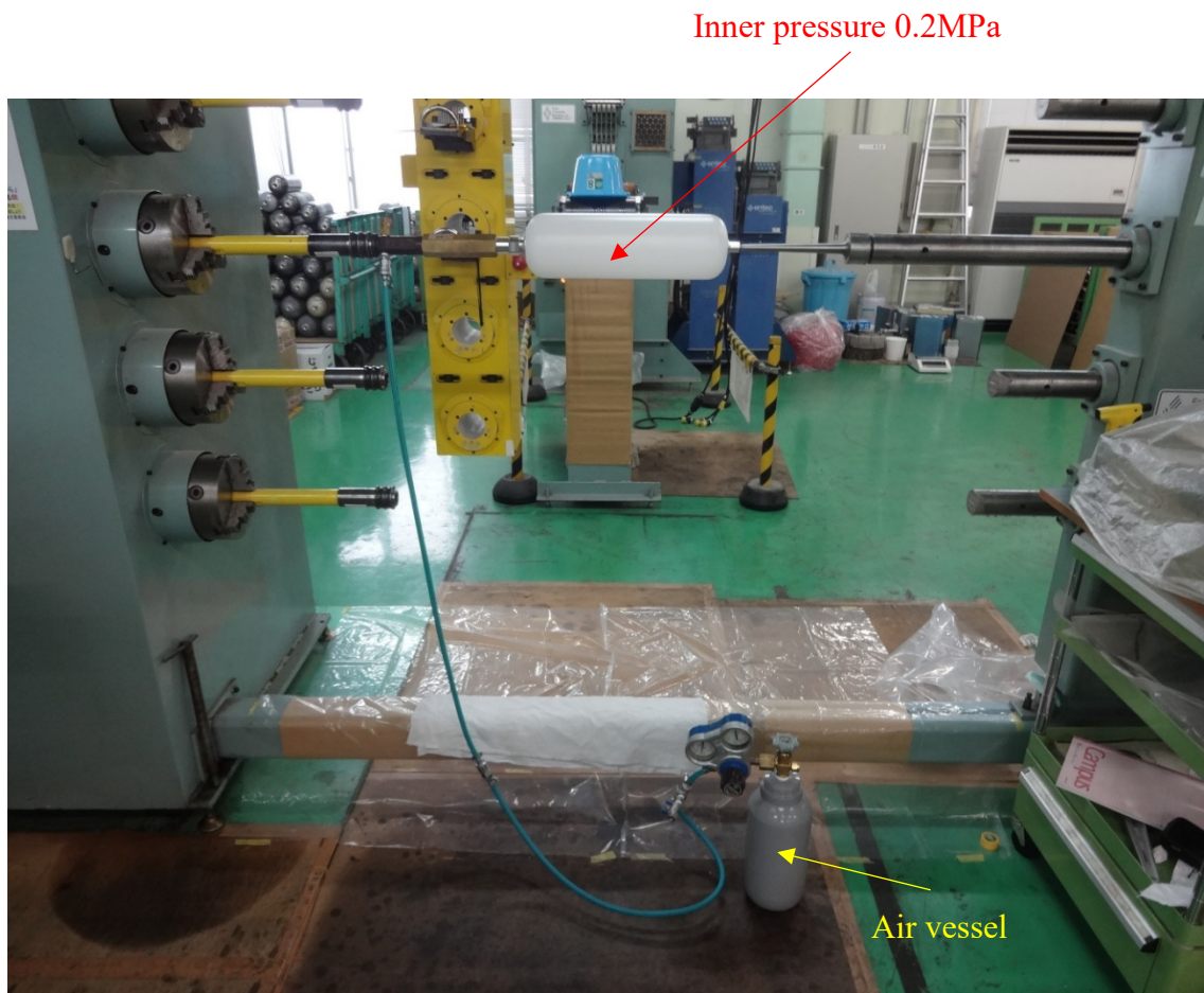
図 4.3 ライナーの接続および空気ガスの充てん状況
