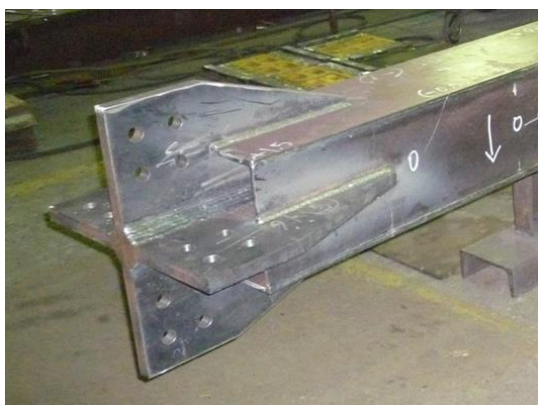
25) 十字プレートと外鋼管の隅肉溶接
