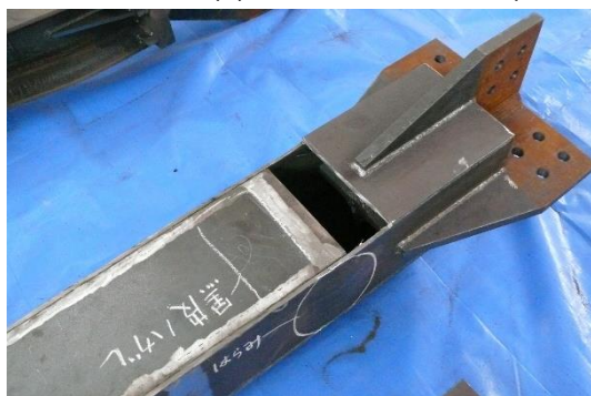
(e) [柱側] 中鋼管(上)・外鋼管(外)
