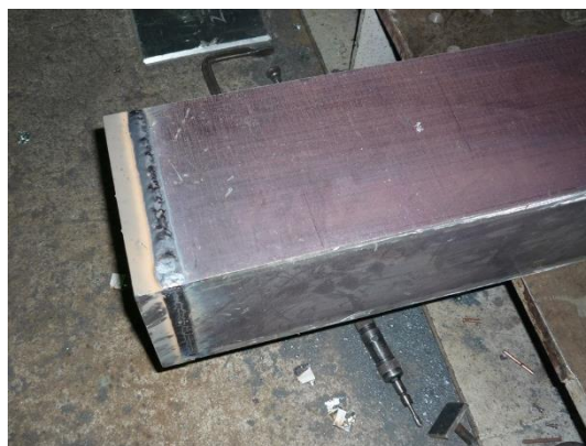
16) 中鋼管と EPL の完全溶込み溶接
