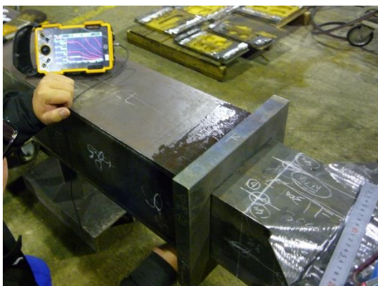
23) 外鋼管と REPL 溶接部の UT 検査
