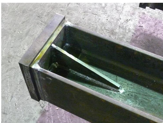
3) 芯材と EPL の完全溶込み溶接(裏研り仕様)
