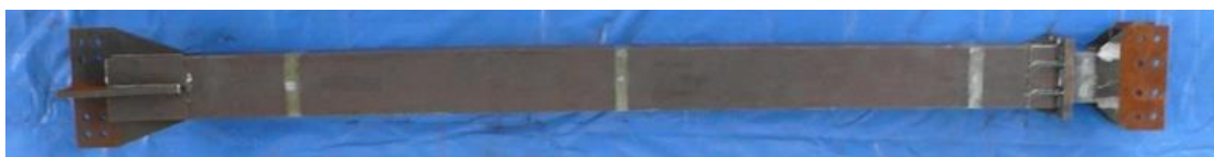
(a) 折返しブレース全景(実験後)
