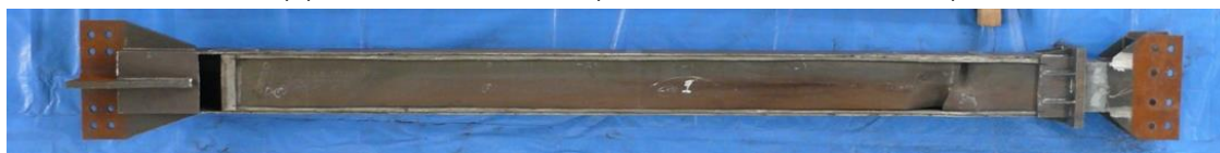
(c) 折返しブレース全景(実験後、外鋼管・中鋼管の上面切断)
