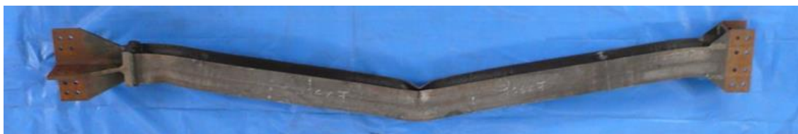
(a) 芯材単体ブレース全景(実験後)
