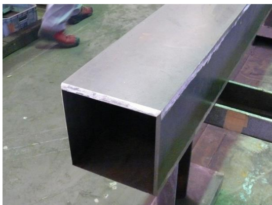
9) 中鋼管の組立溶接(部分溶込み)
