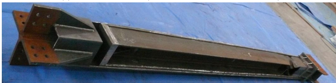
(d) 折返しブレース全景(実験後、外鋼管・中鋼管の上面・側面切断)
