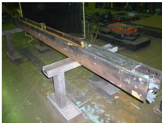
6) カバープレートの部分溶込み溶接
