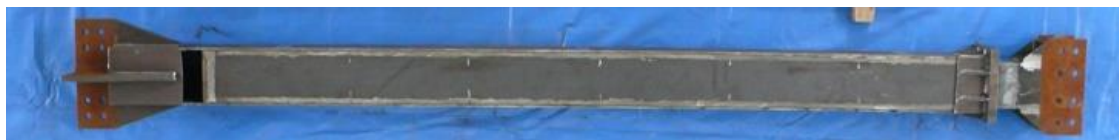
(b) 折返しブレース全景(実験後、外鋼管の上面切断)
