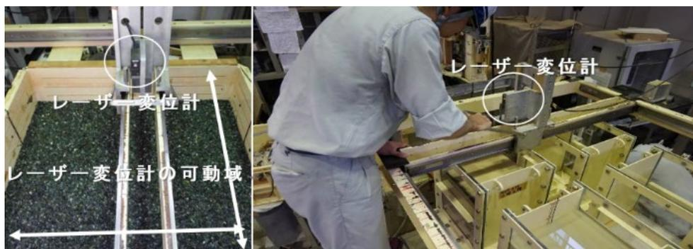
図-3.29 土層全体の鉛直変位の計測状況
