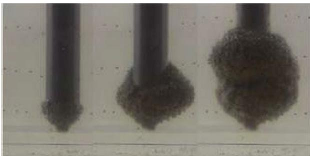
図-4.14 圧入時のモルタルの拡径状況
