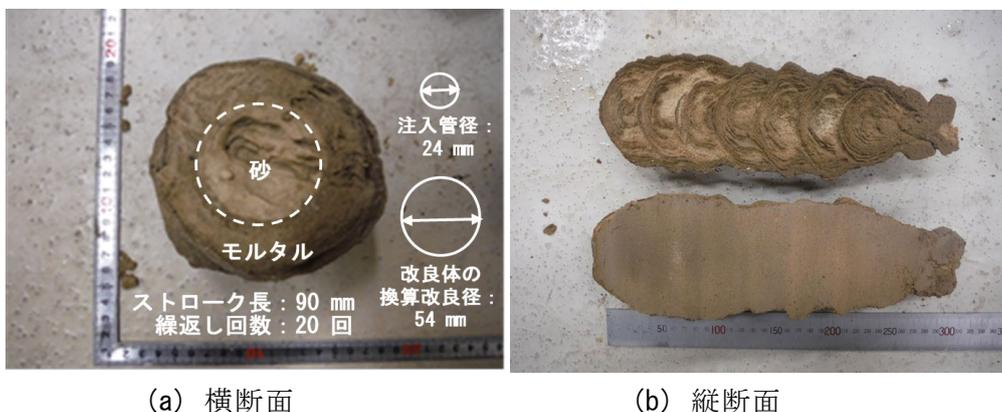
図-3.46 U/D 方式の改良体の断面
