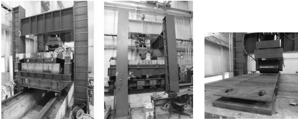
付写真-4.20 輪荷重走行試験機の概要（日本大学）
