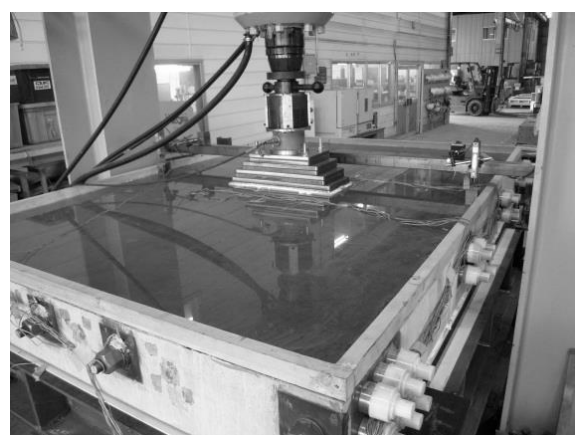
定点疲労試験 水張り時の状態
