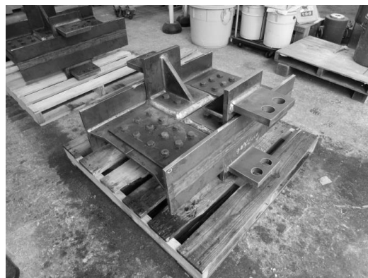
PBL+アングル鋼板, 主桁鋼板
