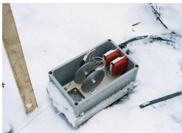
写真 2.8 地表移動量計 (EX-1, EX-2)
