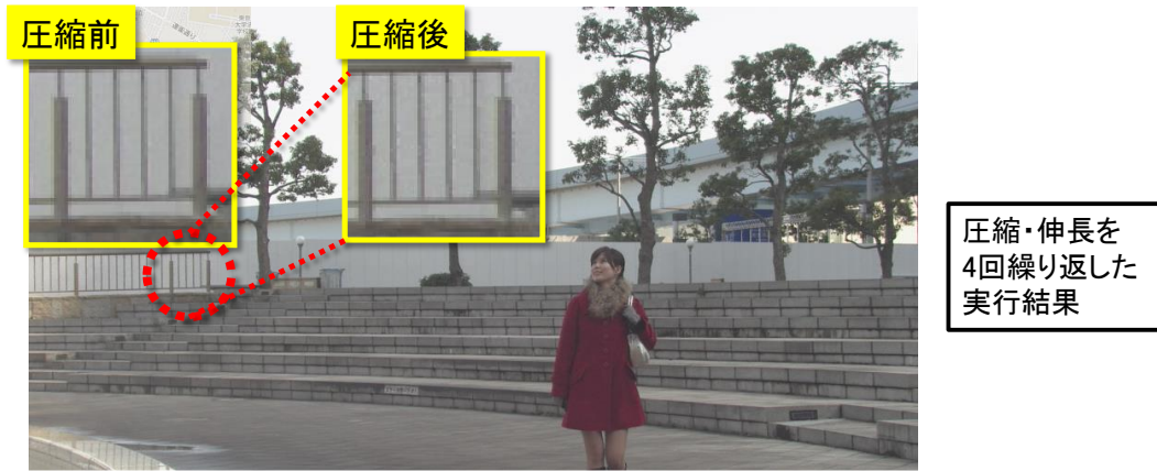
図 4.7 非可逆圧縮方式による圧縮画像例
