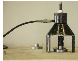
図－ 4.3 建研式引張試験試験の概略図および試験状況例
