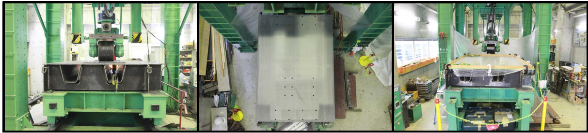
(1) 走行実験による走行 (2) ショットブラスト (3) 防錆剤の塗布
