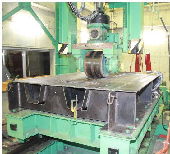
写真－4.2 輪荷重走行疲労装置
