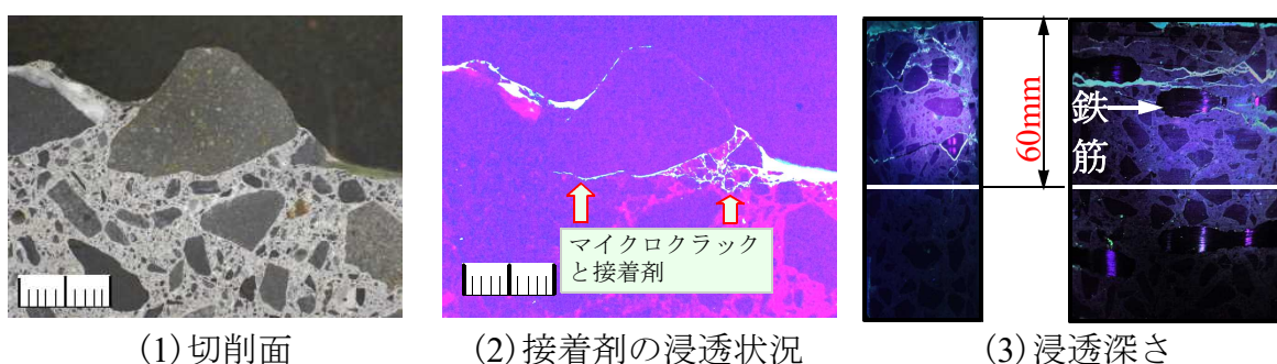
写真－ 3.7 ひび割れ充填観察結果 (1mm/目盛り)
