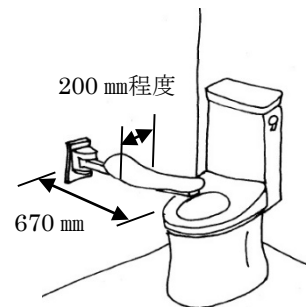
図 7-37 前方支持手すり
