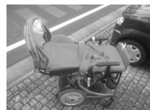
座位ができないため、フルフラットの状態で移動するための車椅子
