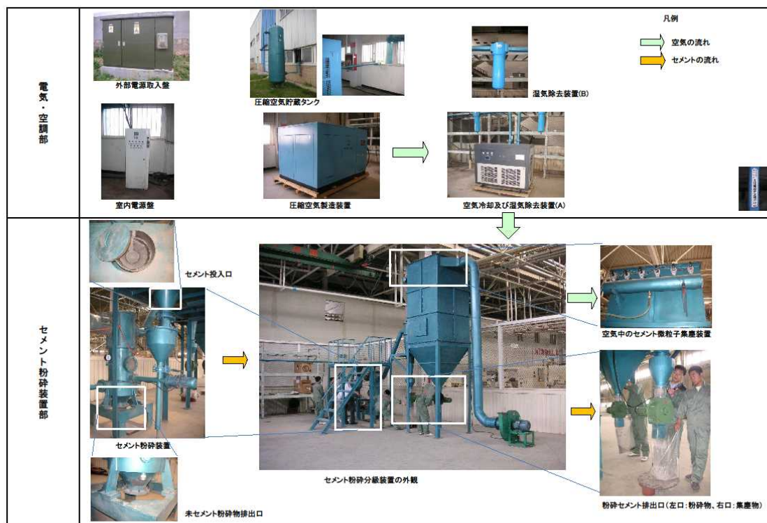
図 5.3.2 微粉碎セメント型速硬性混和材の実用型製造装置
