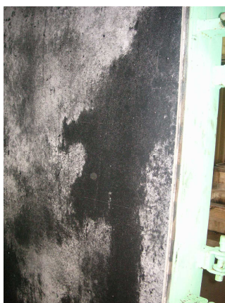
図 4.3.1 離型剤後のノロ付着例
