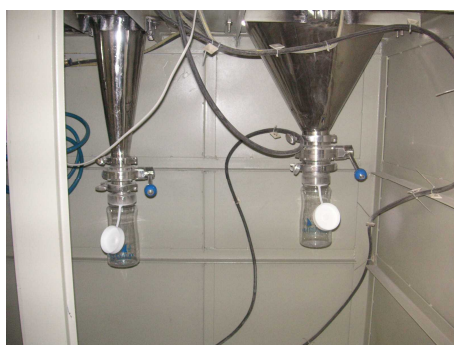
図 5.3.12 粉碎セメントの収集部
