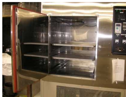
図 6.2.2 蒸気養生装置
