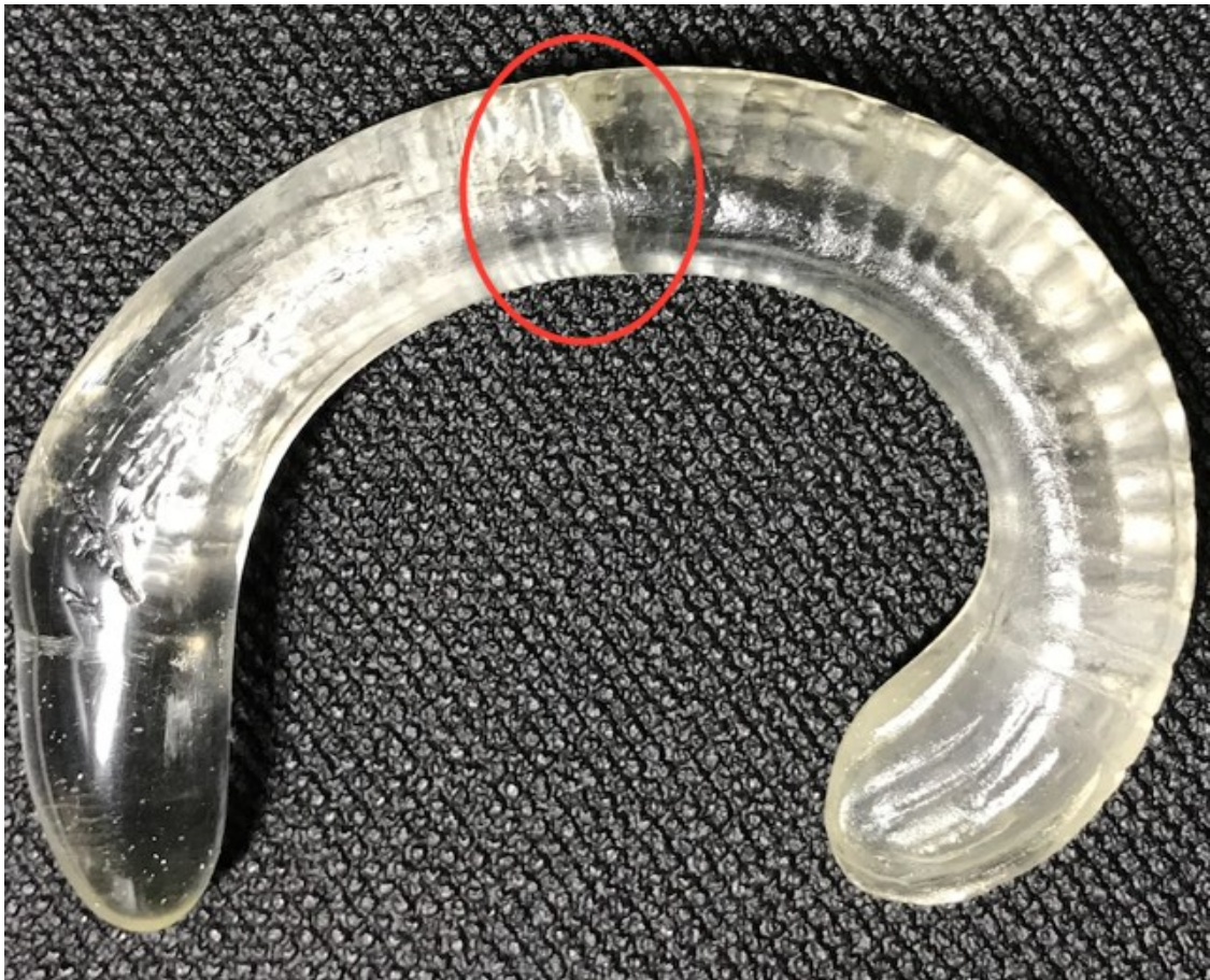
【写真 4-36】 胚体部分の破損の様子
