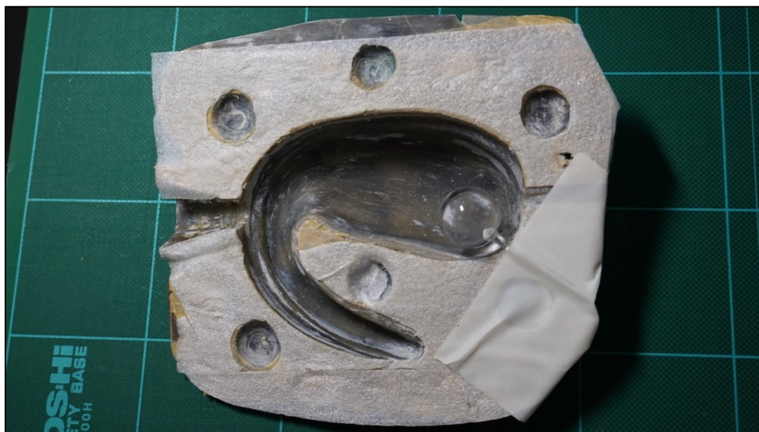
【写真 4-11】 FRP 製の型枠
