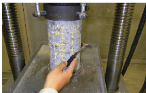
写真5.12 コア試験片での接触時間の測定状況 5.12)
