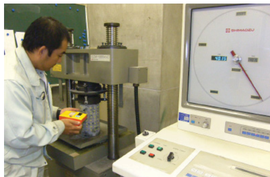
写真5.11 反発度の測定状況 5.12)
