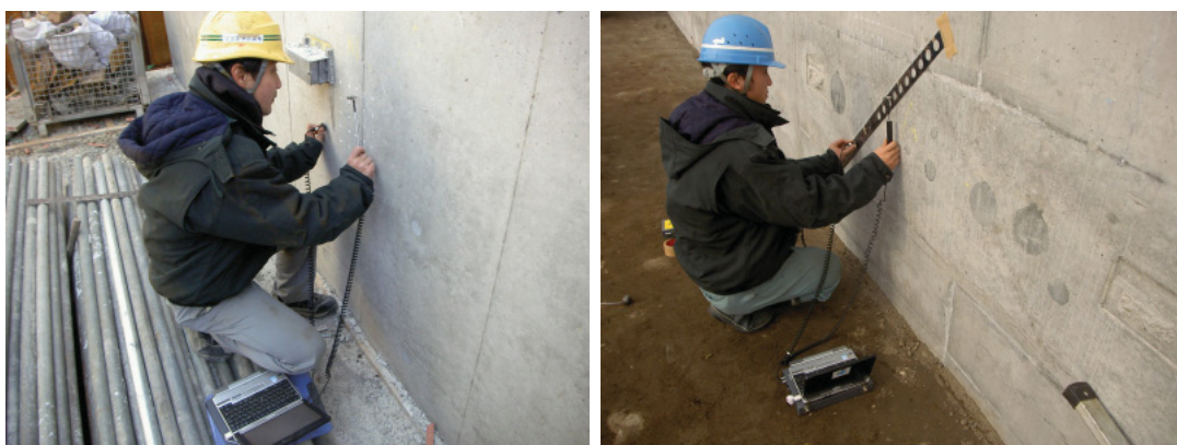
写真4.2 縦弾性波速度の測定状況（左：構造物S4，右：構造物W）
