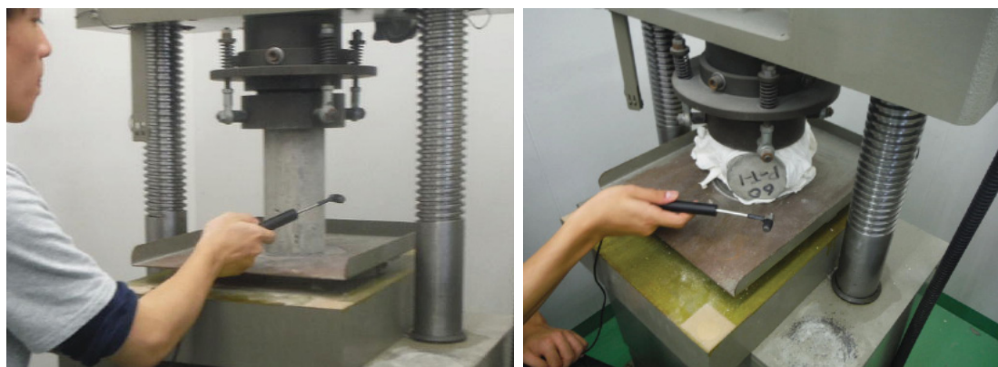
(a) 円柱供試体の側面での測定 (b) 円柱供試体の底面での測定 写真4.6 円柱供試体での接触時間の測定状況
