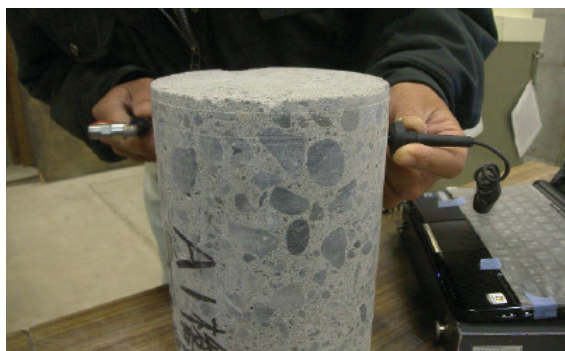
写真5.10 対面配置法の測定状況 5.12)
