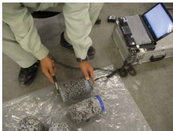
写真5.4 円柱供試体での測定状況
