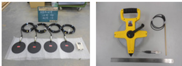
(d) 土圧計及び水位計
