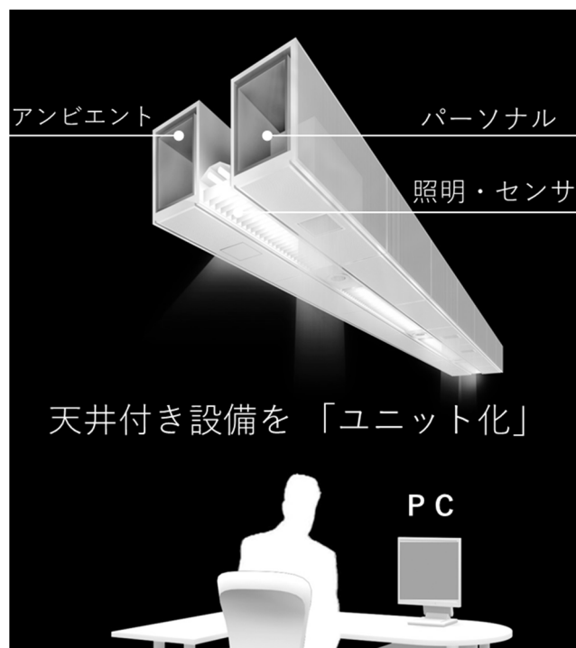
図 5.2-6 パーソナル空調システム
