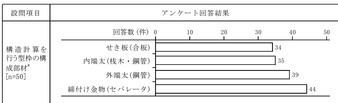
図2.4.3(3) 構造計算を行う型枠の構成部材
