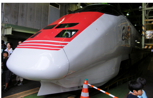
図 1.2.10: 軌道検測車 (East.i)
