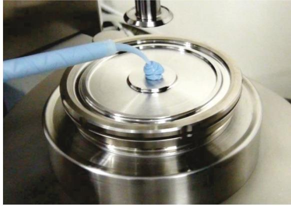
Fig. 2 ストレス制御型レオメーターのステージ
