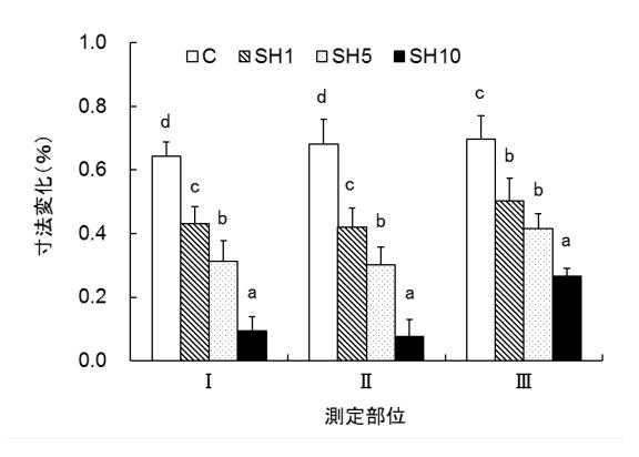
第6図 DAJ-AFP連合印象による石膏模型の寸法変化
