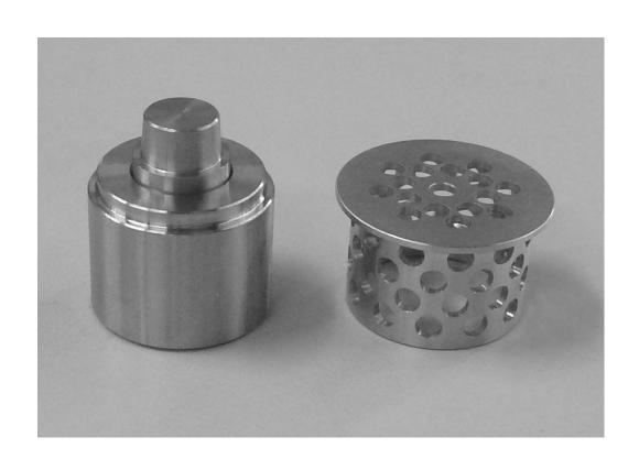
第1図 ステンレス鋼製支台歯模型(左)と印象用金属トレー(右)
