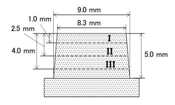
第2図 支台歯模型の寸法および測定部位
