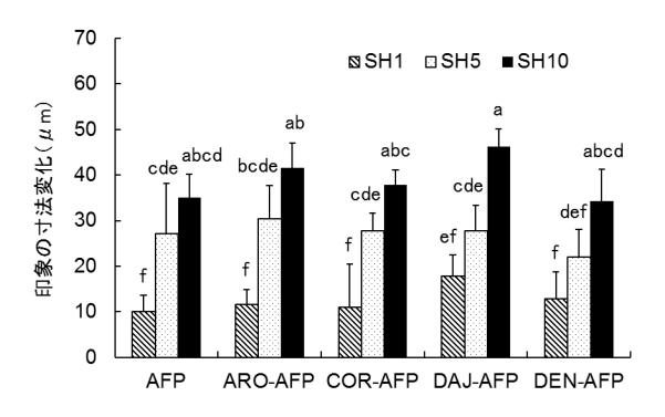
第8図 部位 I (上面から1mm) における印象の寸法変化
