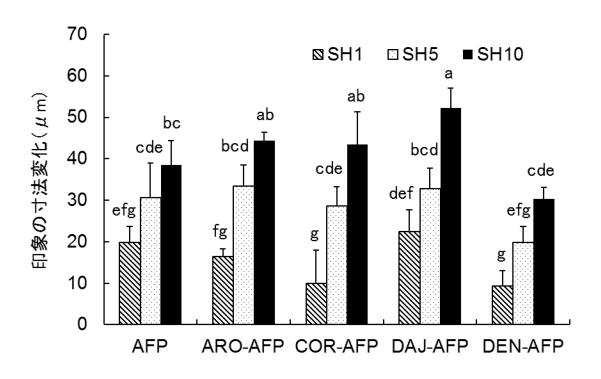
第9図 部位 II (上面から2.5 mm) における印象の寸法変化 同一英小文字に有意差なし (p>0.05)
