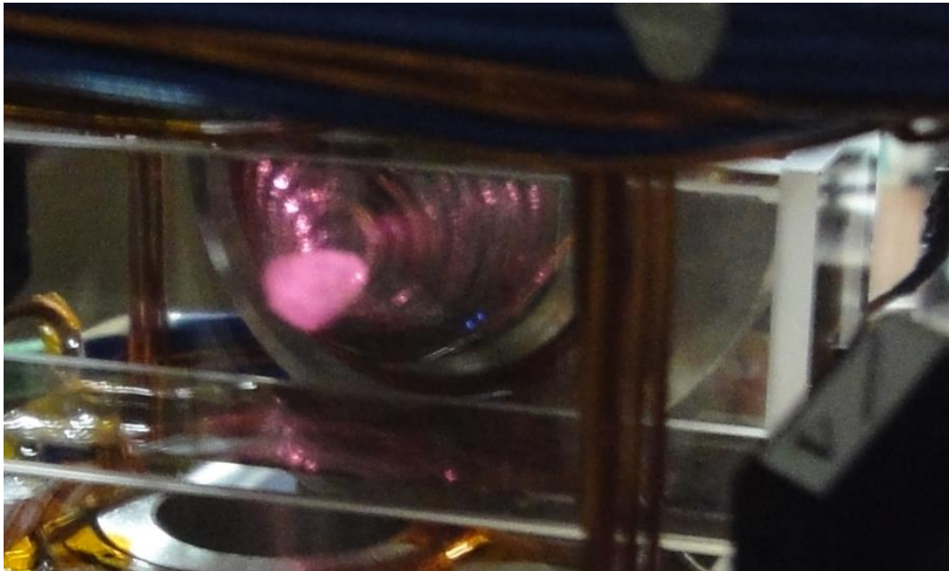
図 3.6 MOT 中の冷却原子集団の写真。写真中央のガラスセル内にある涙型のピンクの発光体が、MOT に捕獲された ^{87}\text{Rb} の冷却原子集団である。
