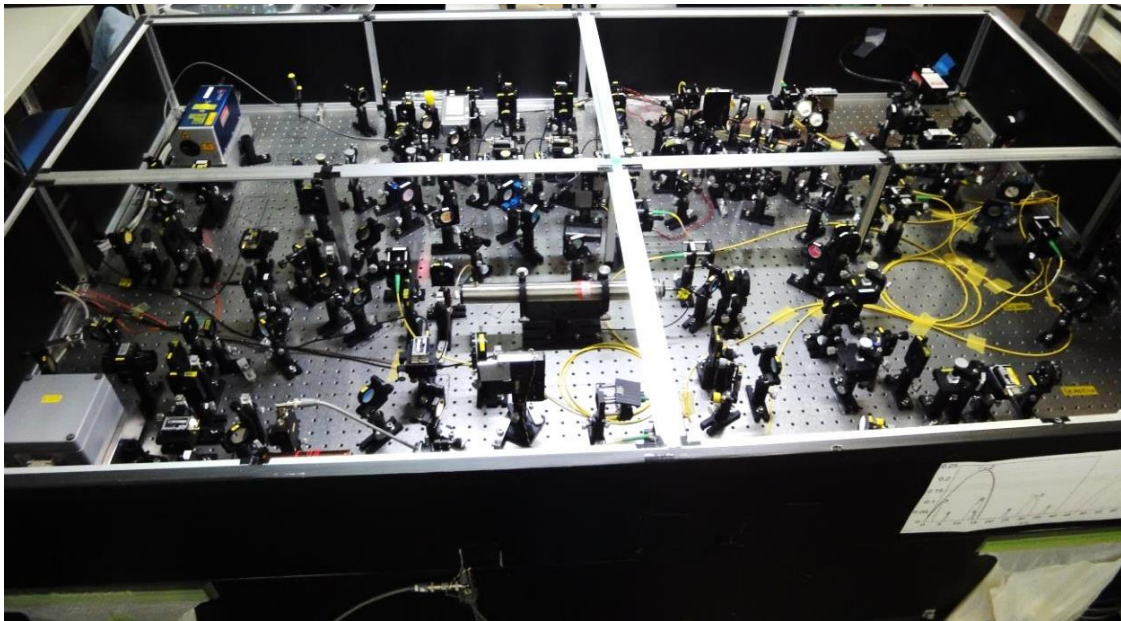
図 3.8 構築した光学系の写真。実験中は外気にふれレーザーや各オプティクスが不安定になることや漏れ光によりボース凝縮体生成に影響を及ぼさないために、遮光ボックスで光学系全体を覆っている。
