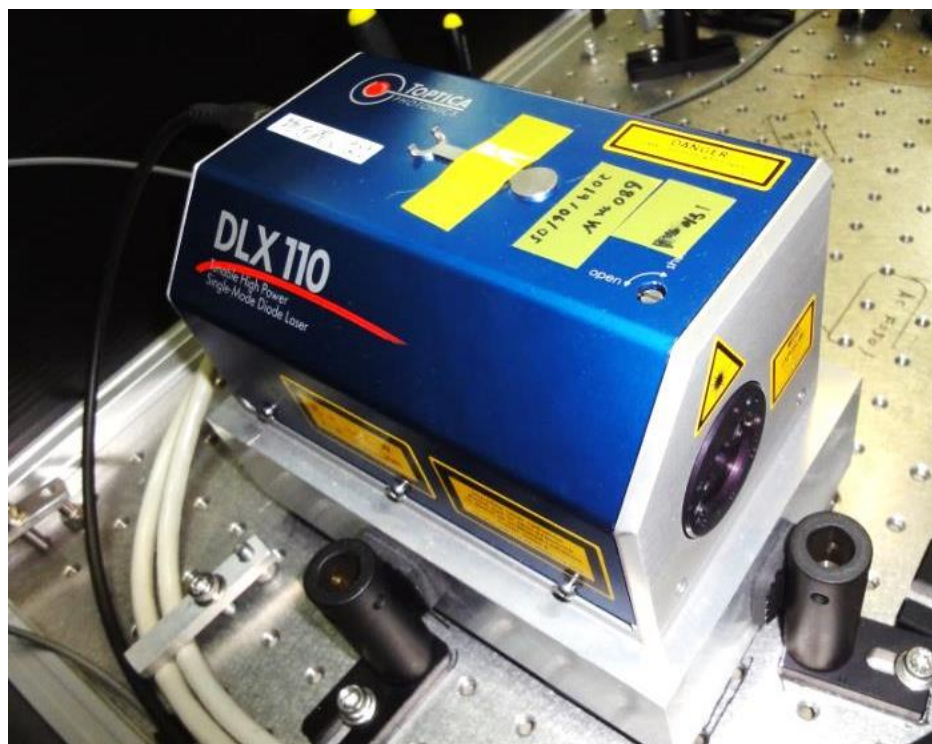
図 3.9 メインレーザーの写真。Toptica 社の DLX110。出力は 680 mW。
