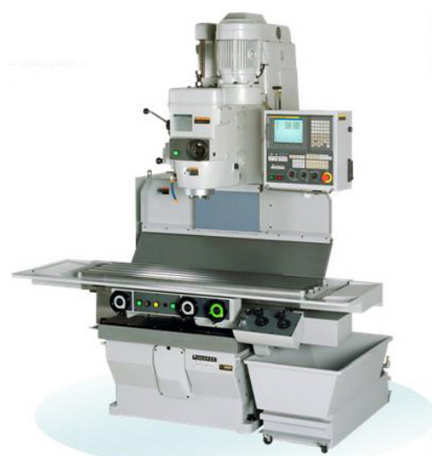
図 4.2 NC 立型フライス盤の一例 2)3) 株式会社山崎技研社製 YZ-400NCR
