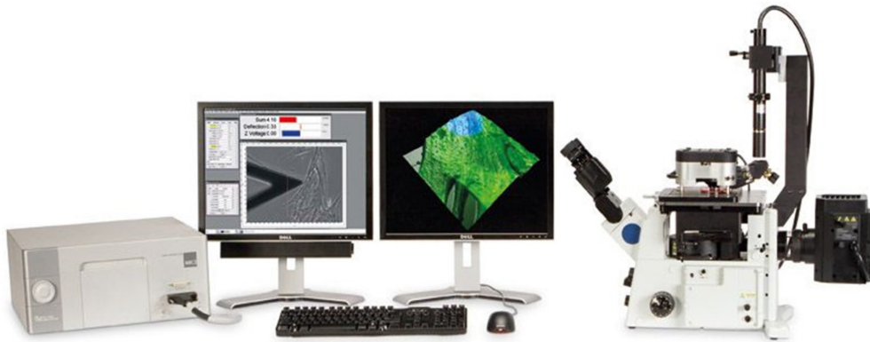
図 1.9 原子間力顕微鏡の一例 オックスフォード・インストゥルメンツ株式会社製 原子間力顕微鏡システム Cyper
