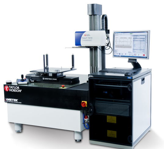
図 1.7 触針式表面粗さ測定機の一例 Taylor Hobson 社製フォームタリサーフ i-シリーズ
