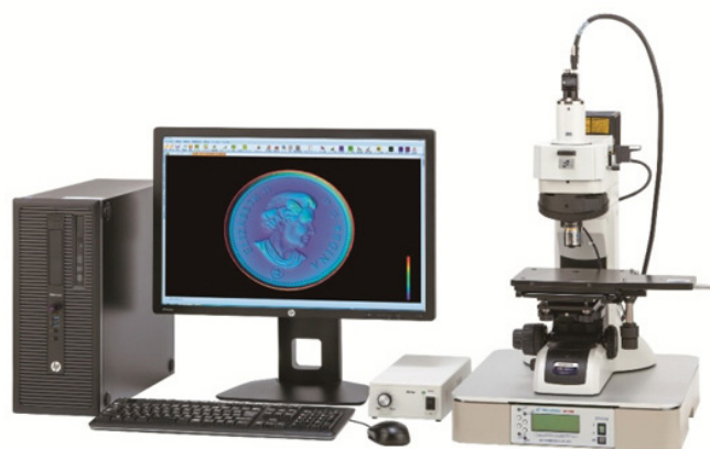
図 1.11 走査型白色干渉顕微鏡の一例 株式会社日立ハイテクサイエンス社製 走査型白色干渉顕微鏡 VS1000 シリーズ http://www.hitachi-hightech.com/hhs/products/tech/em/wi/descriptions/
