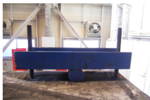
写真-3.2.3 浮上り防止装置
