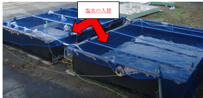
写真-3.4.1 塩害促進状況(浸漬供試体)
