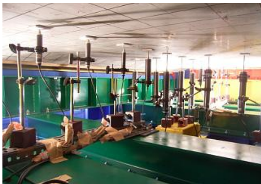
写真-3.2.4 高感度変位計の設置状況
