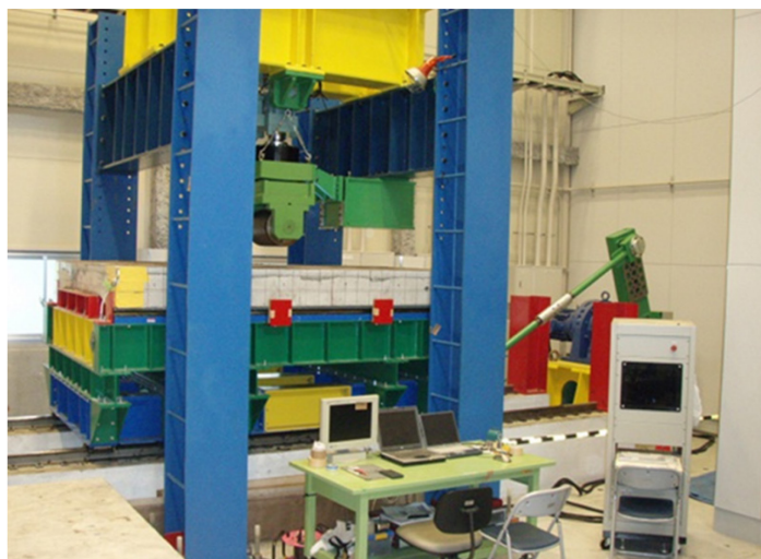
写真-3.2.1 輪荷重走行試験装置 8)
