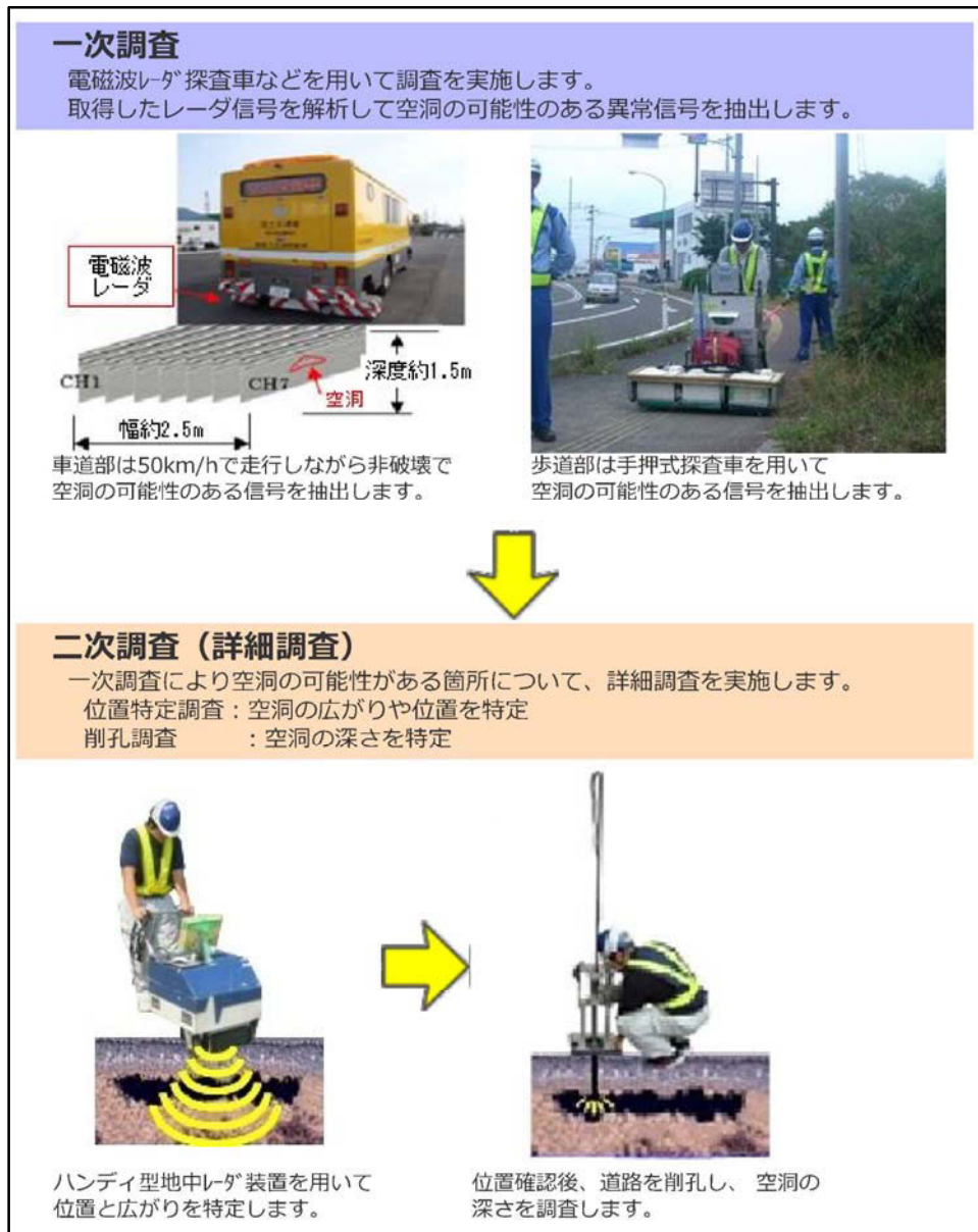
図-1.2.1 路面下空洞調査方法 8)
