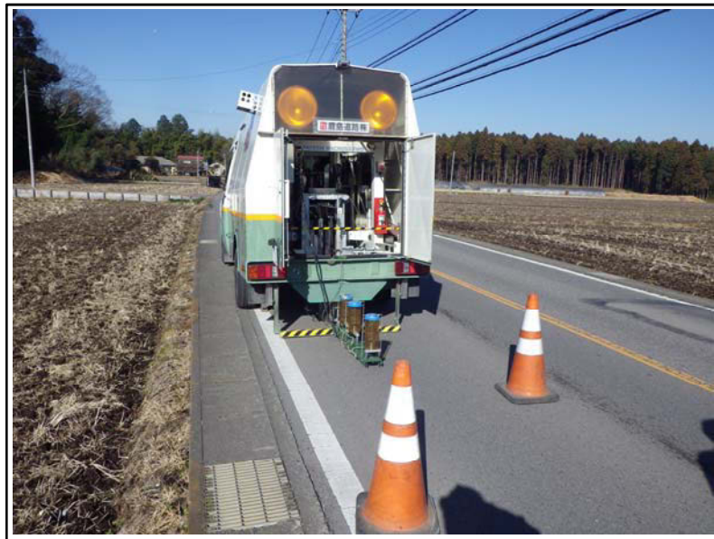
写真-2.3.2 車載型 FWD による調査状況 10)
