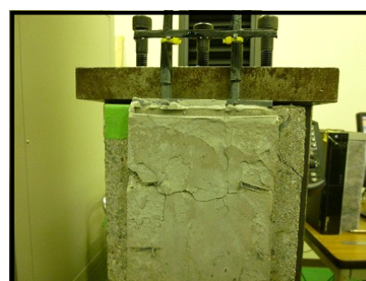
(2) 接着剤 N を用いた供試体
