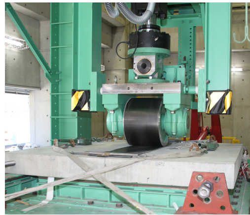
写真－6.4 輪荷重走行疲労試験装置
