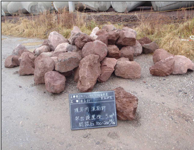
波高計方塊架台固定用間詰石(5m 3 )
